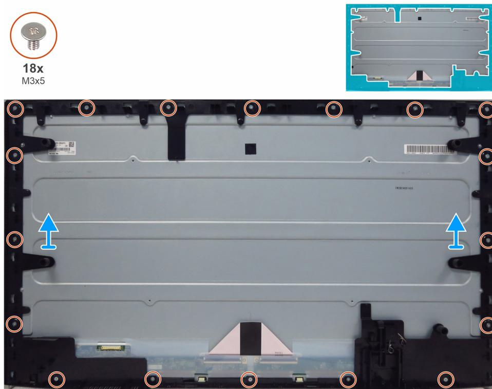
**Figura 7. Desmontaje del marco central**
