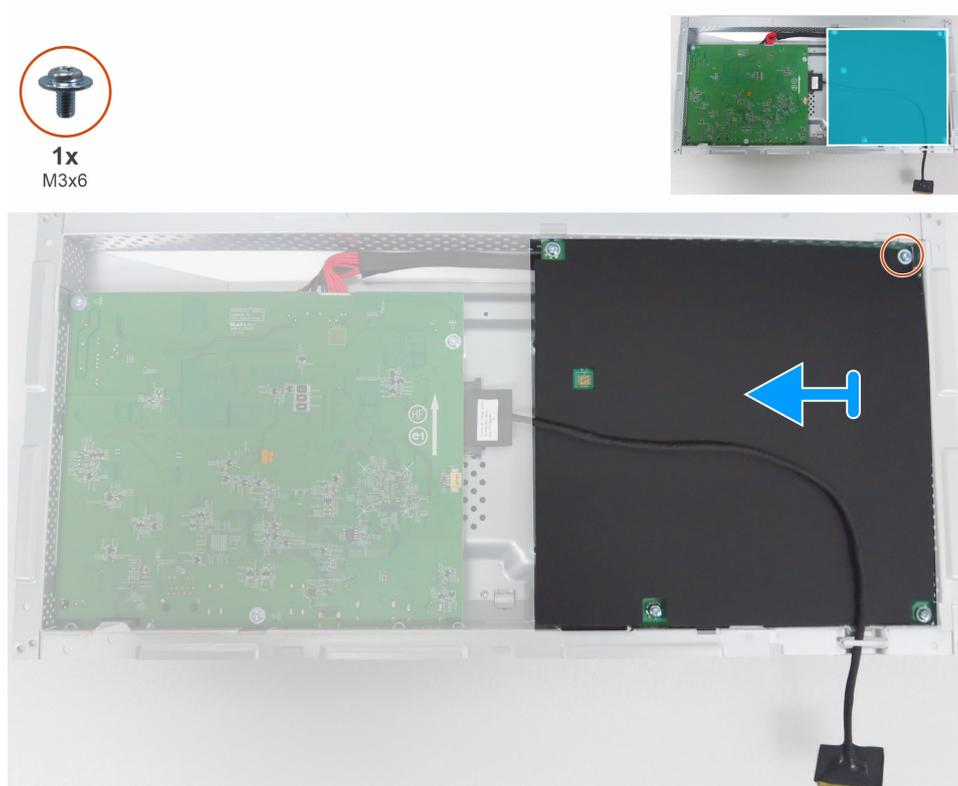
**Figura 8. Retirada de la lámina de Mylar**
