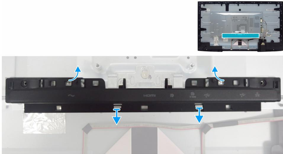
**Figura 4.** Desmontaje de la tapa de E/S
