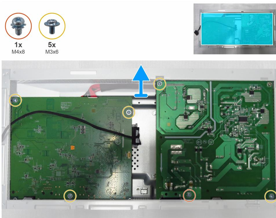
**Figura 9.** Desmontaje de la placa base y de la placa de alimentación
