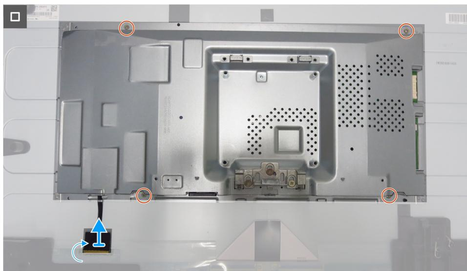
**Figura 6. Desmontaje del chasis principal**
