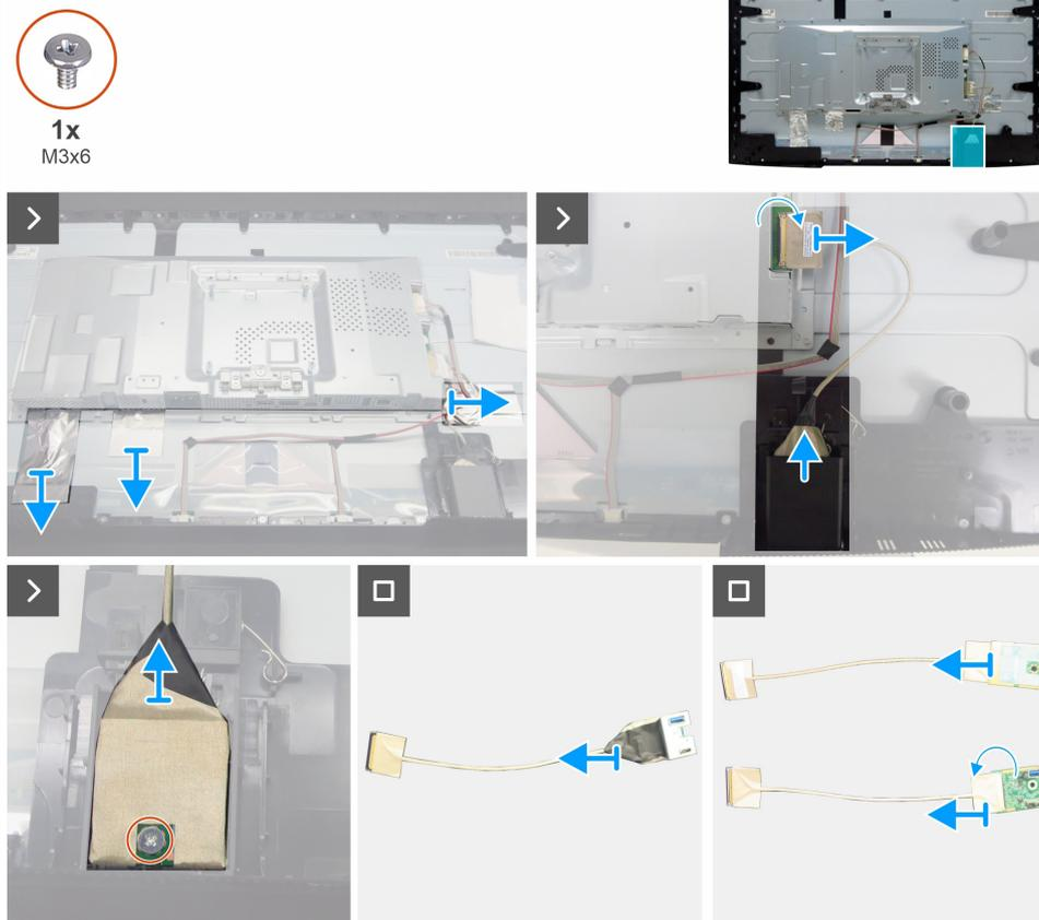
**Figura 5. Desmontaje de la placa USB**
