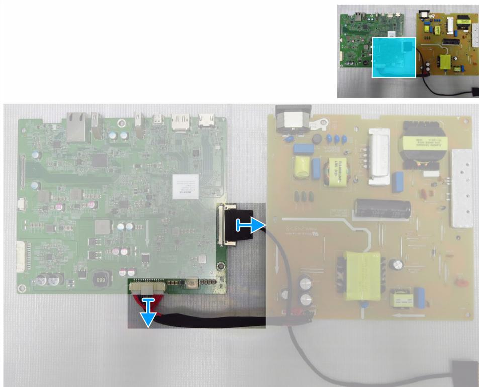
**Figura 10.** Desconexión de los cables de la placa base
