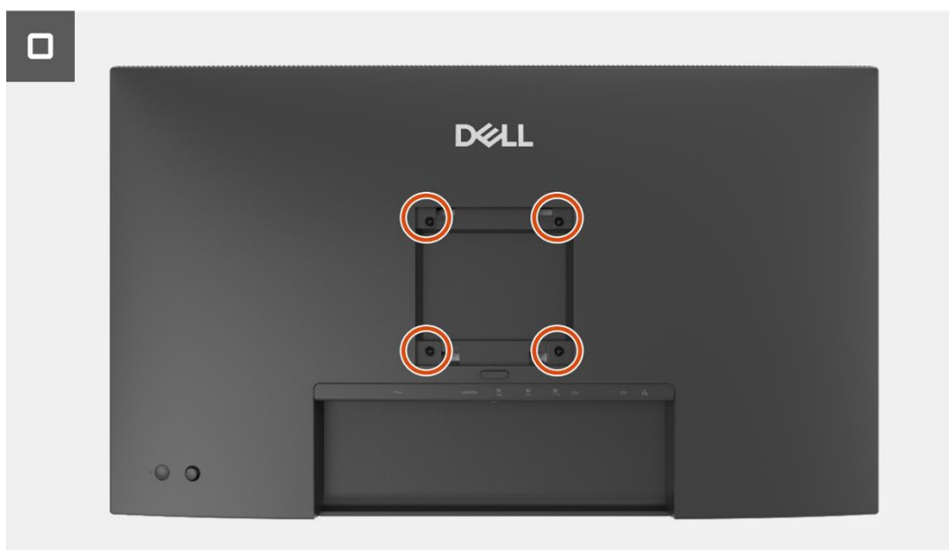
Obrázek 55. Instalace zadního krytu
