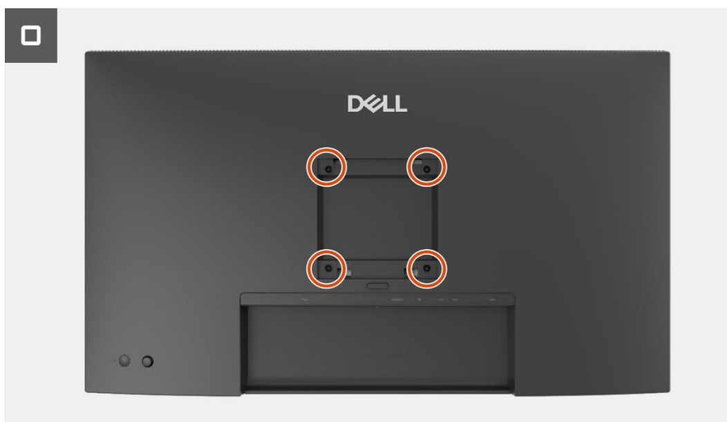
Obrázek 25. Instalace zadního krytu
