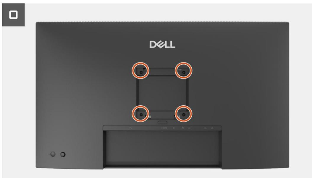
**Figura 68.** Instalação da tampa traseira
