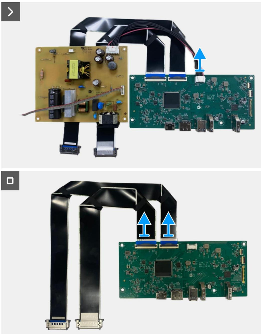
Figura 21. Remoção da placa de interface
