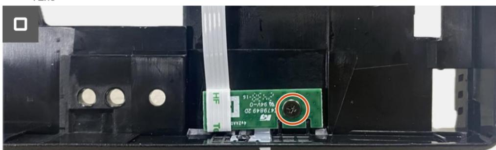
**Figura 58.** Remover a placa de LEDs
