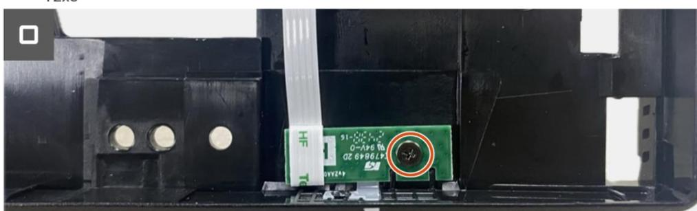
**Figura 88.** Remover a placa de LEDs
