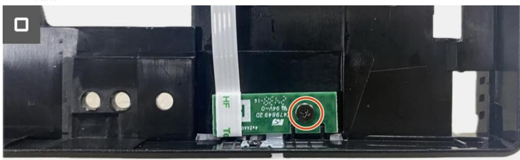
**Figura 28.** Remover a placa de LEDs
