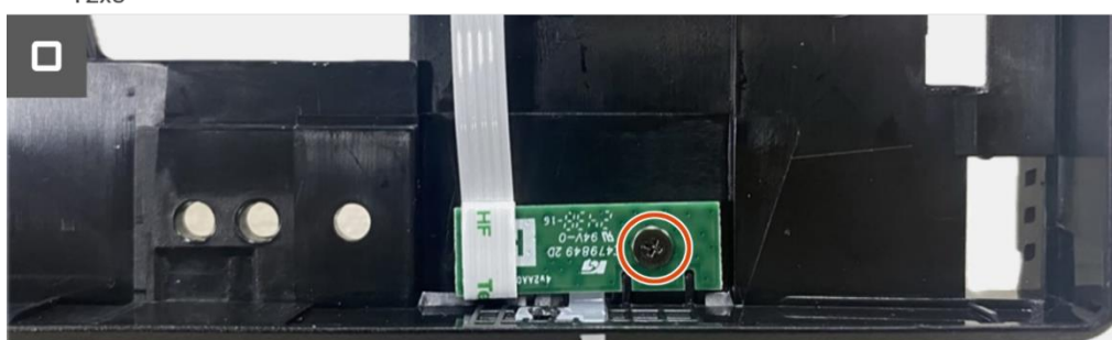
Obrázek 88. Odmontování desky LED
