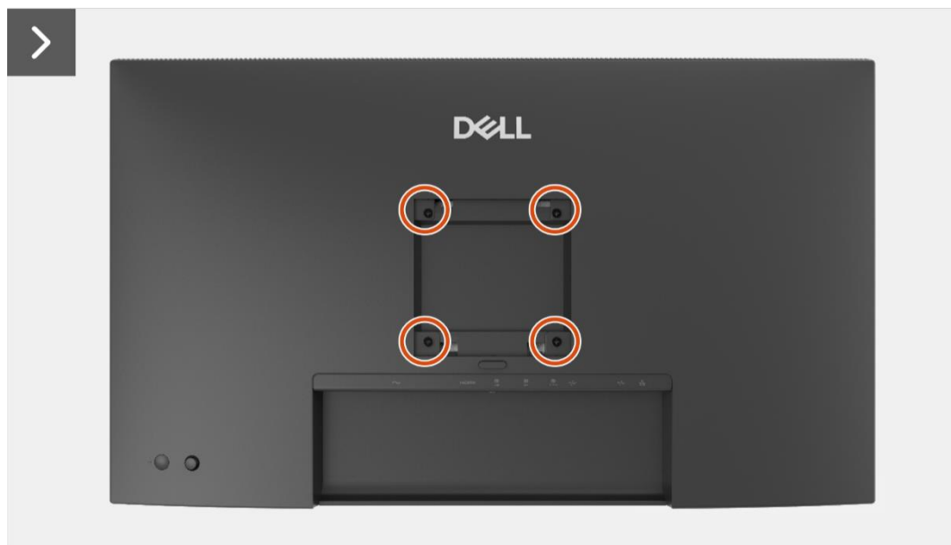
Figura 35. Rimozione della copertura posteriore
