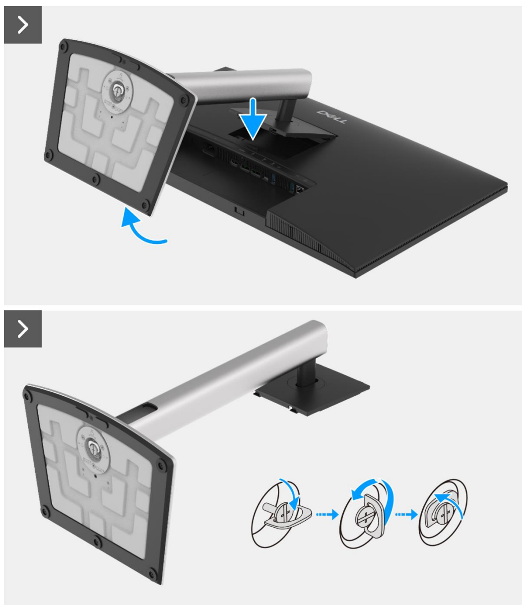
Figura 61. Rimozione del supporto
