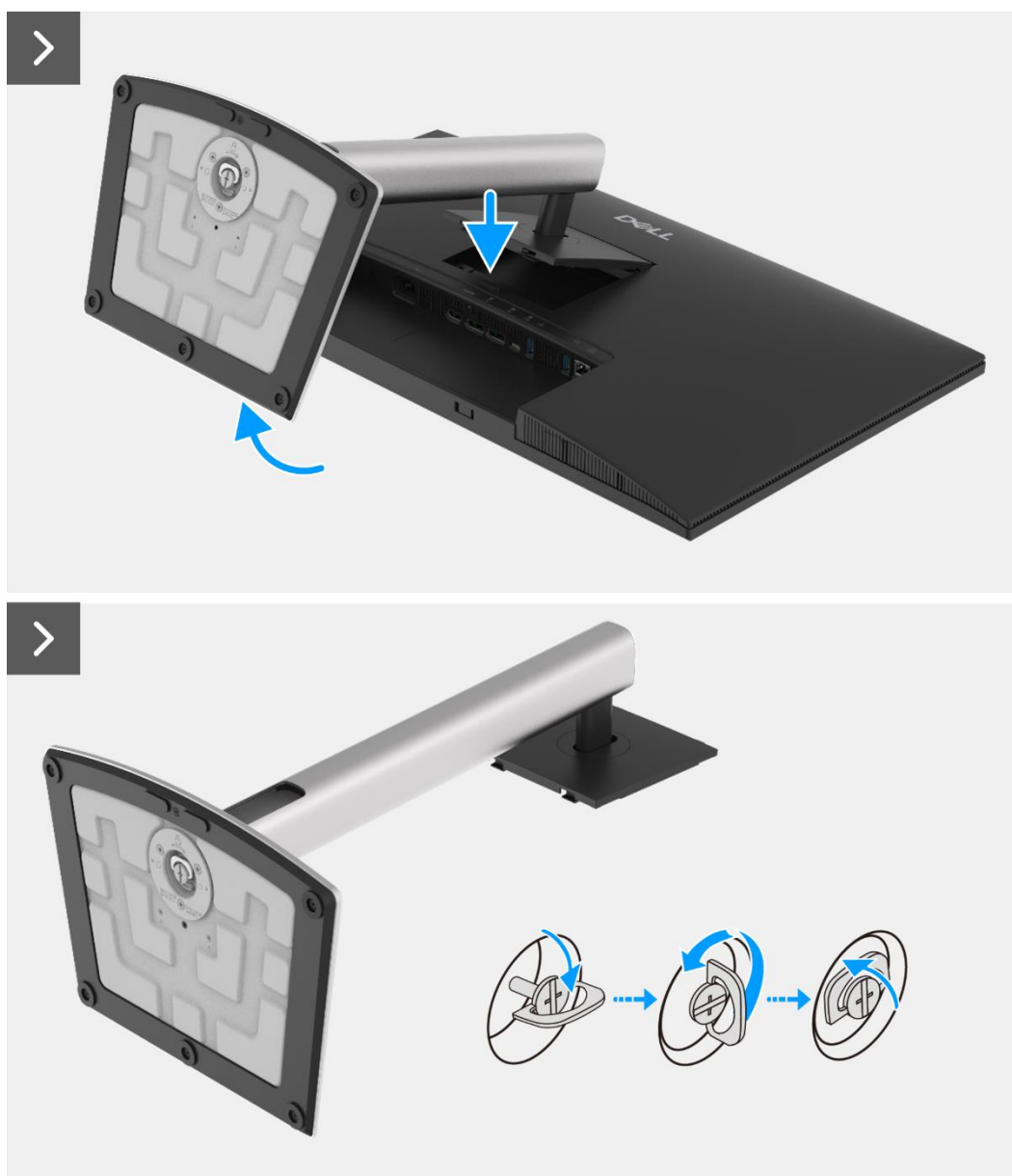
Figura 31. Rimozione del supporto
