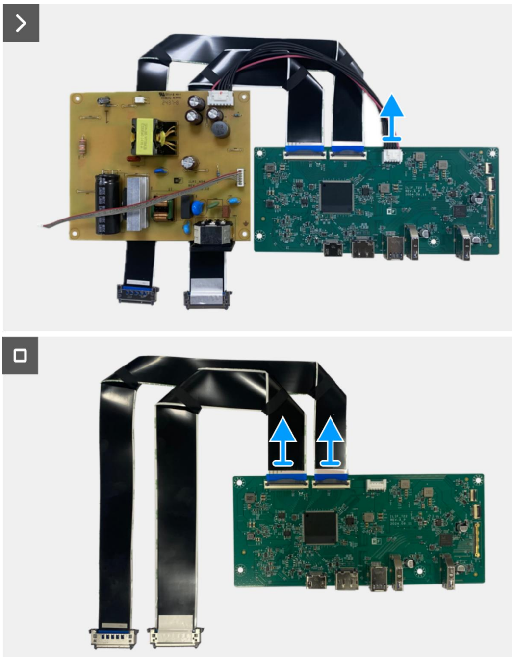
Figura 21. Rimozione della scheda di interfaccia
