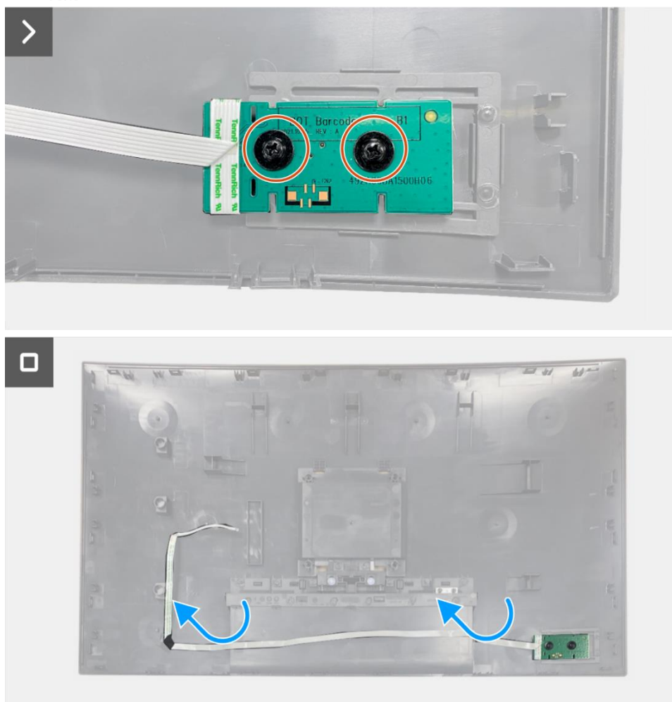
Figura 69. Rimozione della scheda della tastiera
