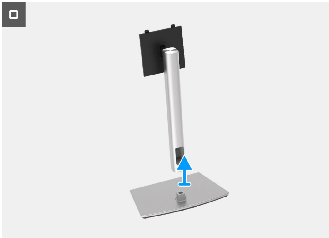
Figura 32. Rimozione del supporto
