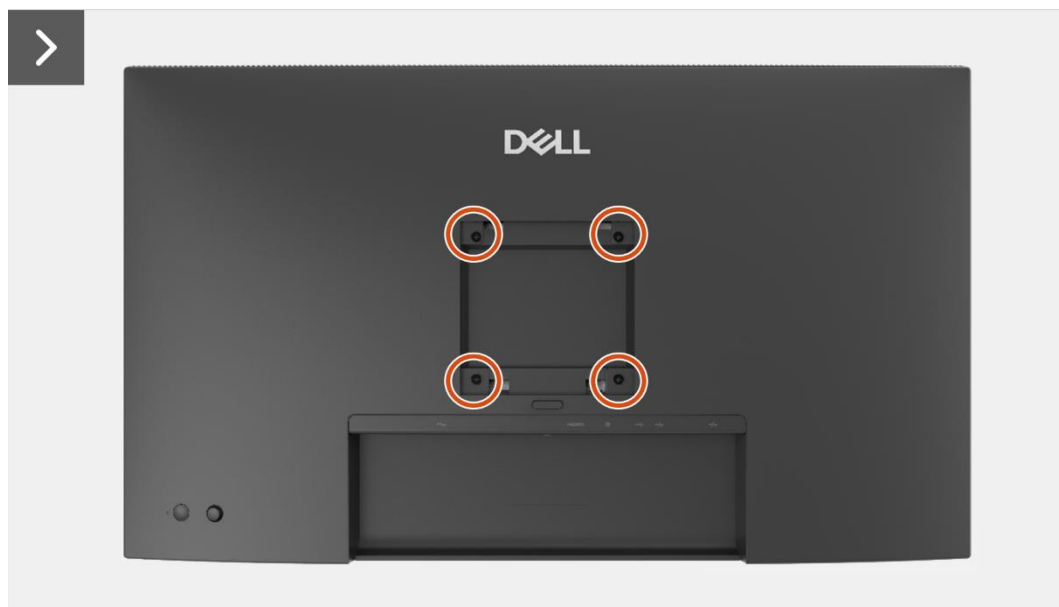
Figura 5. Rimozione della copertura posteriore
