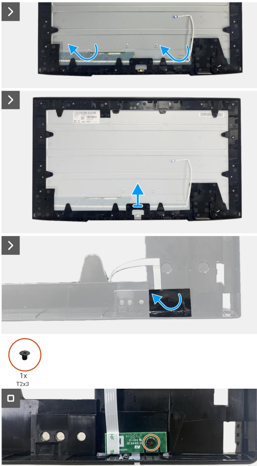
Imagen 45. Extracción de la placa LED
