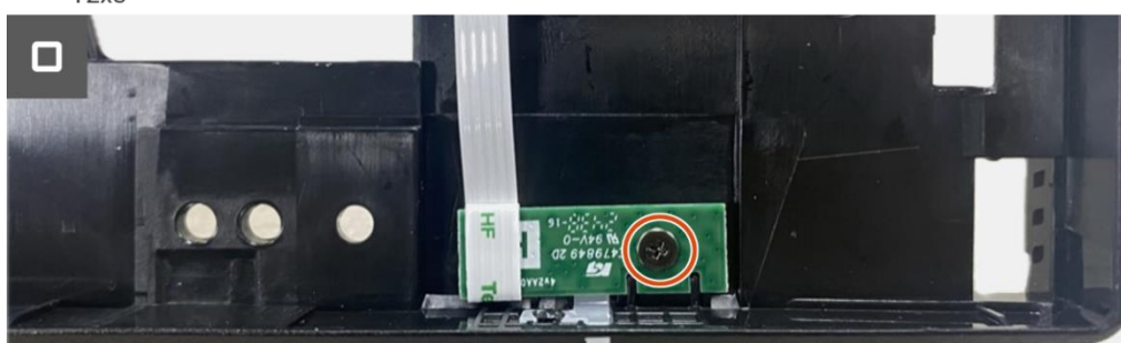
Imagen 105. Extracción de la placa LED
