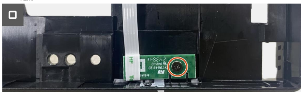
Imagen 75. Extracción de la placa LED
