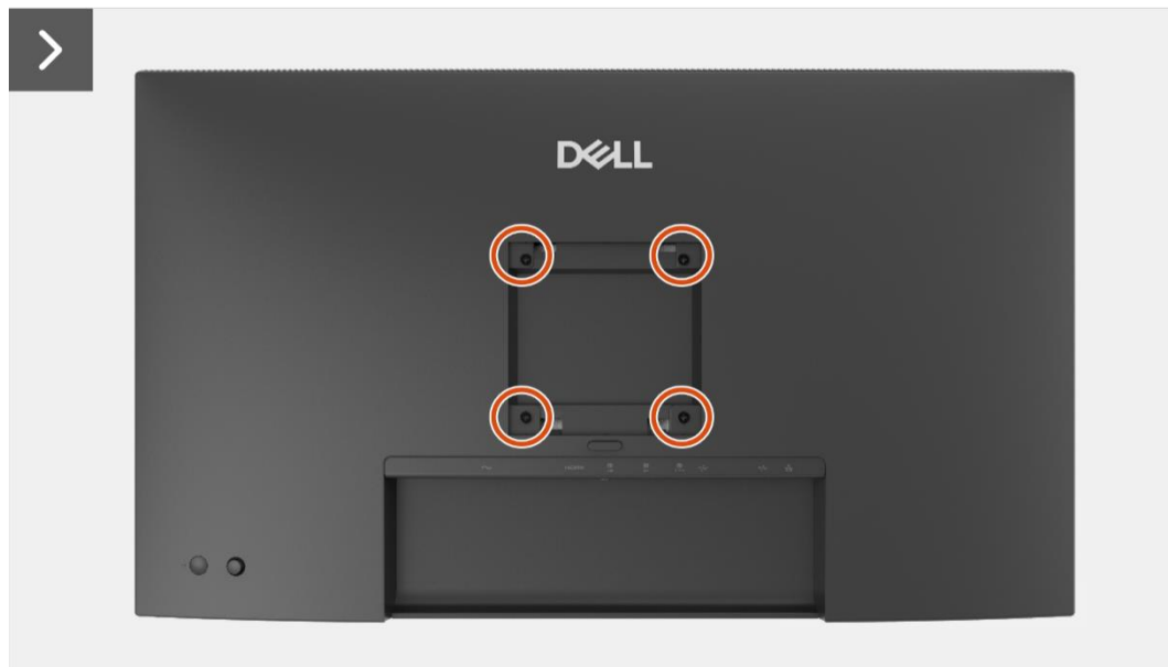
Imagen 52. Extracción de la cubierta trasera
