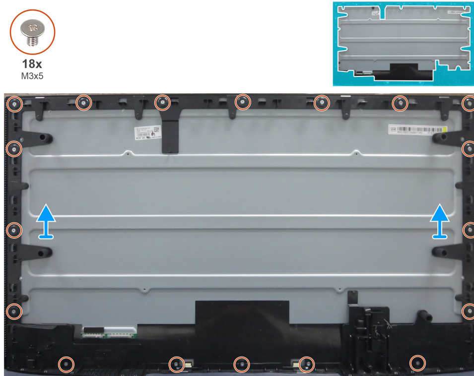
Figura 7. Rimozione del telaio centrale
