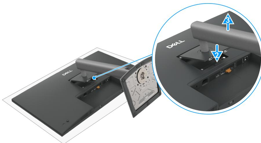
**Figura 55. Remover o suporte do monitor**
