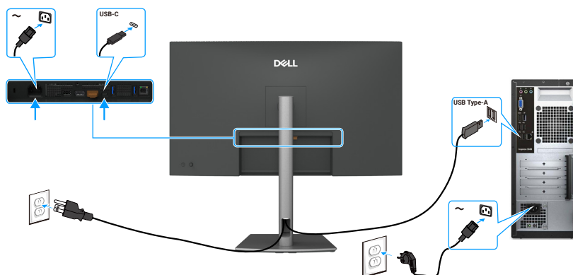
Bild 33. Ansluta USB-C till A-kabeln
