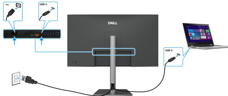
Figure 36. Connexion du câble USB-C
