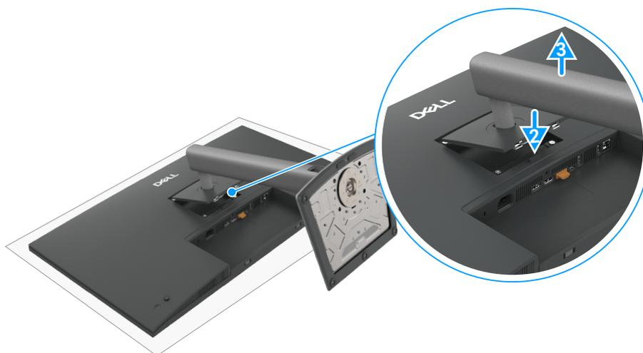
**Figure 55. Démontez le socle du moniteur**
