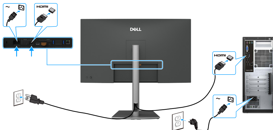
Figure 8. Branchement du câble HDMI
