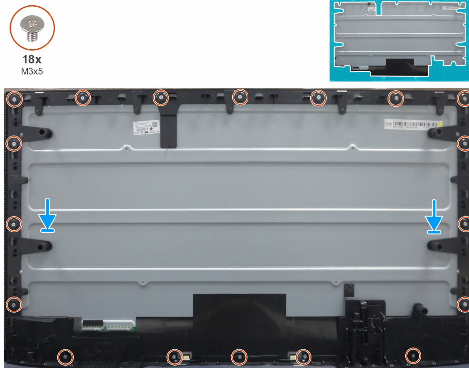
Rysunek 28. Instalowanie ramy wewnętrznej
