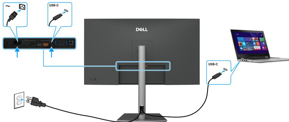
Figura 11. Conexión del cable USB-C a C
