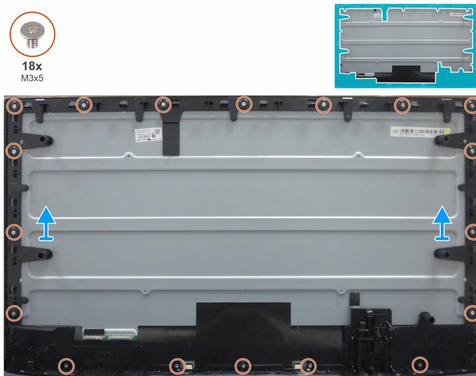
**Figura 27. Desmontaje del marco central**
