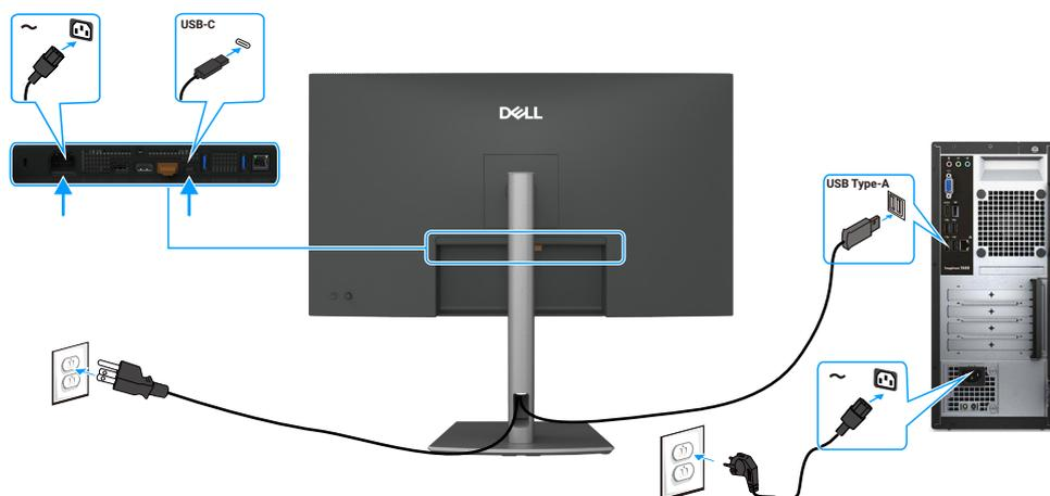
Figura 13. Conexión del cable USB tipo C a tipo A
