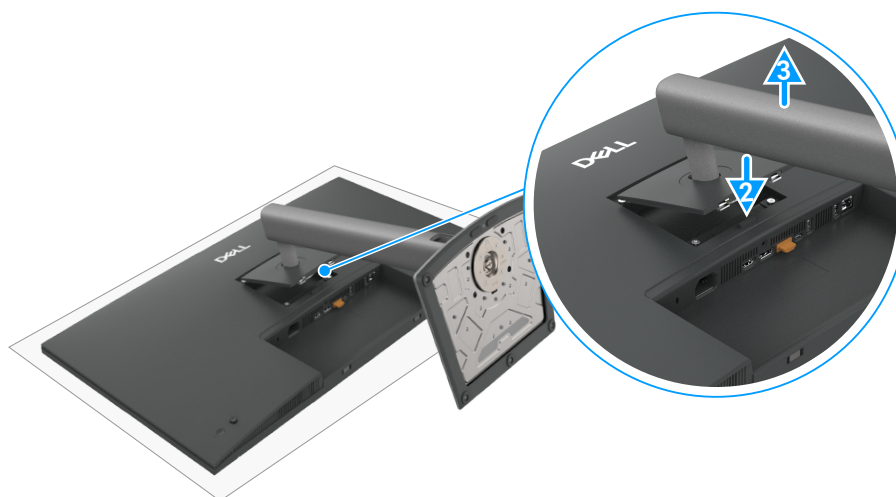
Figura 55. Desmontar el pedestal del monitor
