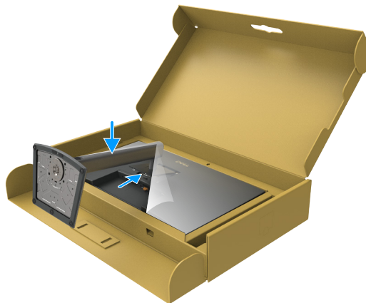
Figura 20. Inserte las pestañas del elevador del soporte en las ranuras
