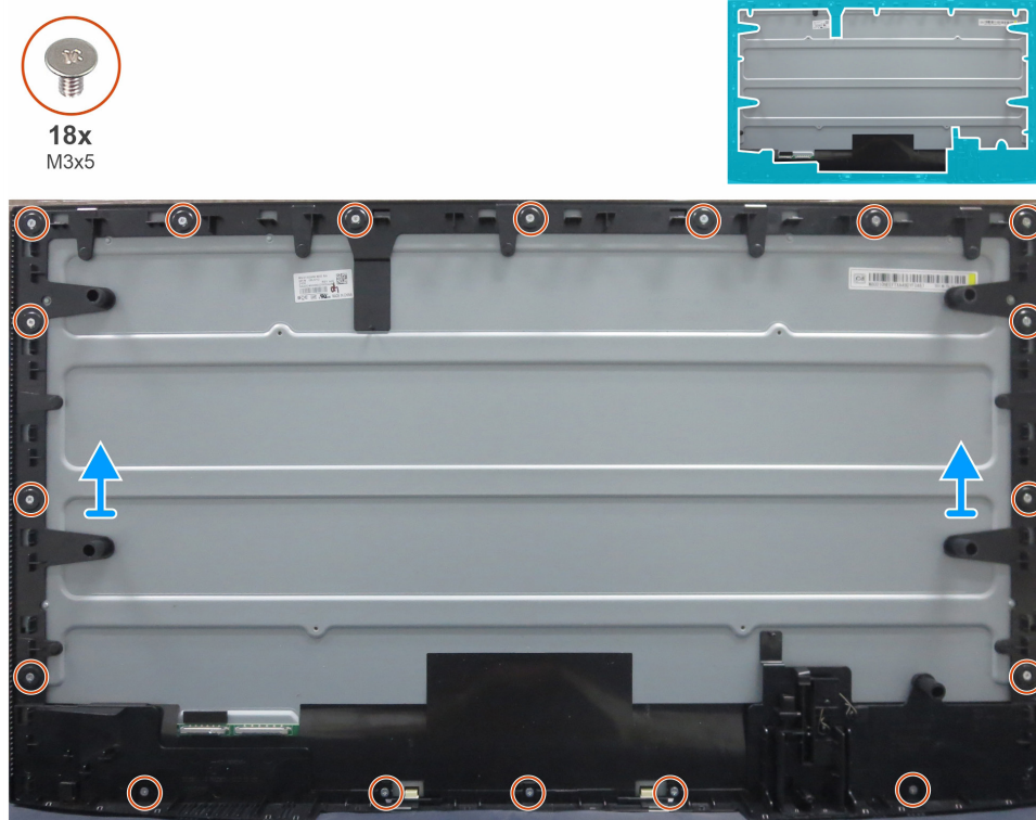
Figura 7. Desmontaje del marco central
