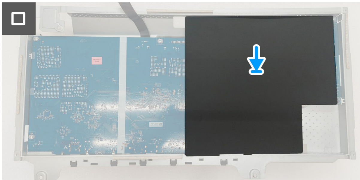
Obrázek 14. Instalace desky se zdrojem LED
