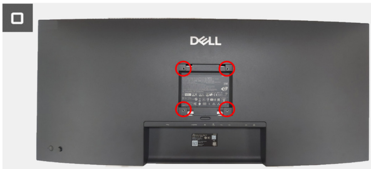
Obrázek 6. Instalace zadního krytu
