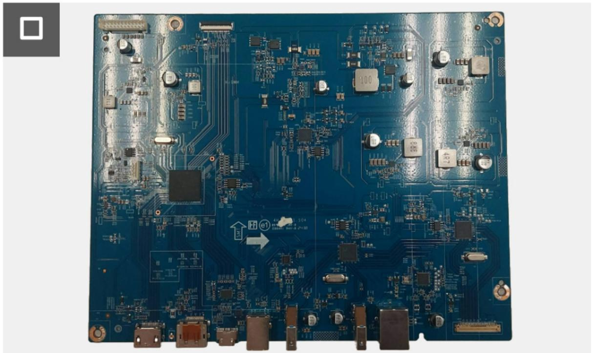
**Figura 28.** Remover a placa da interface
