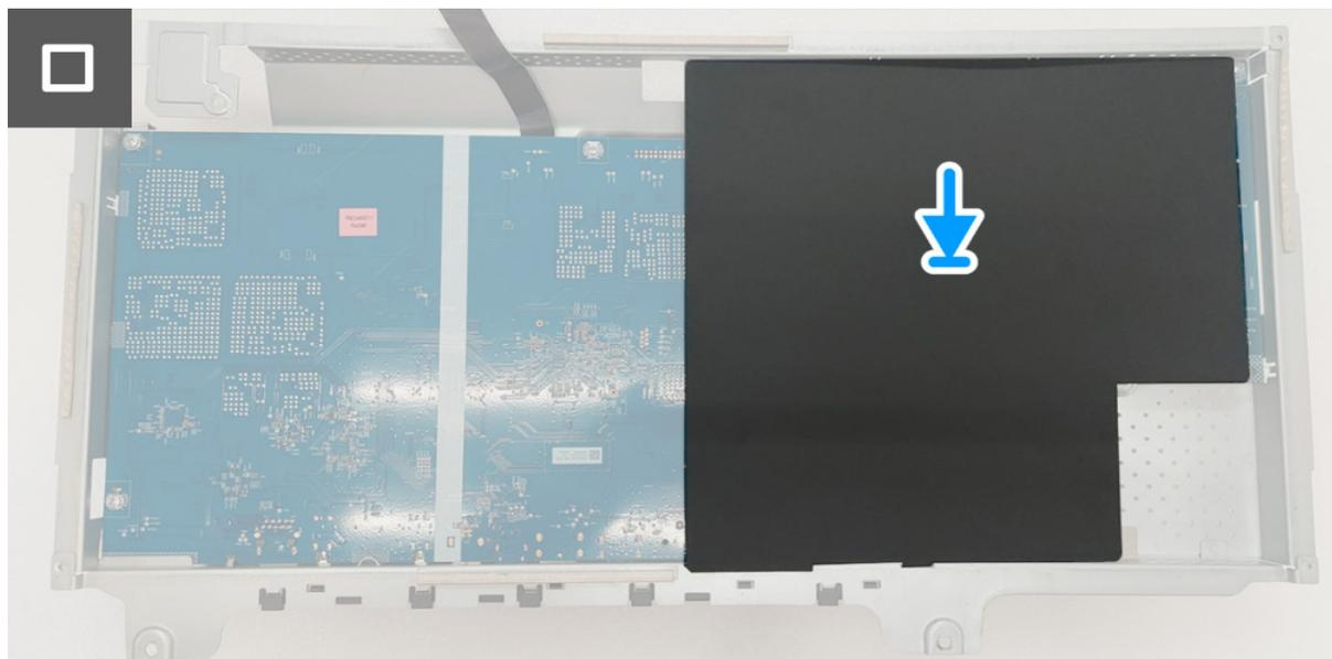
**Figura 26.** Instalar a placa controladora LED
