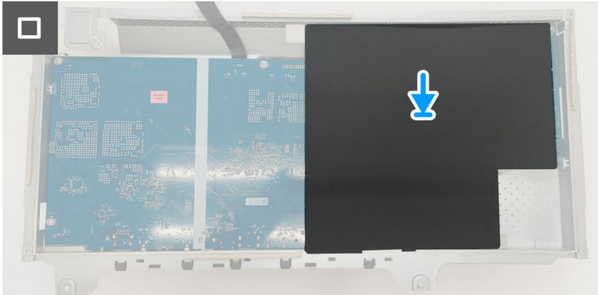
**Figura 14. Instalar la placa de control LED**
