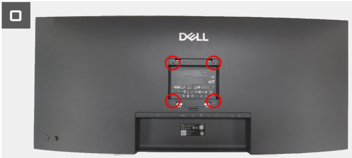
**Figura 6. Instalar la cubierta posterior**
