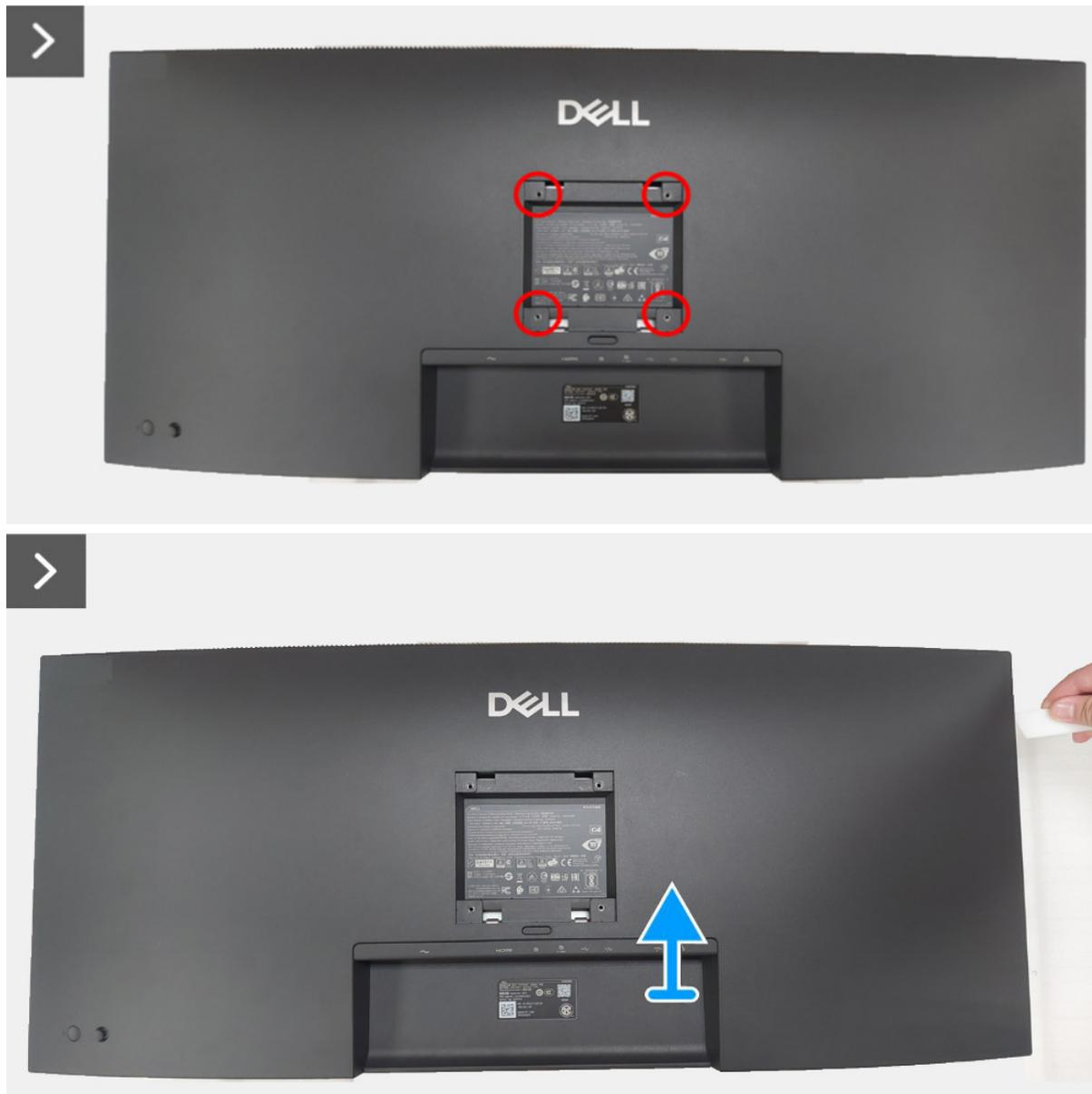
**Figura 3.** Retirar la cubierta posterior
