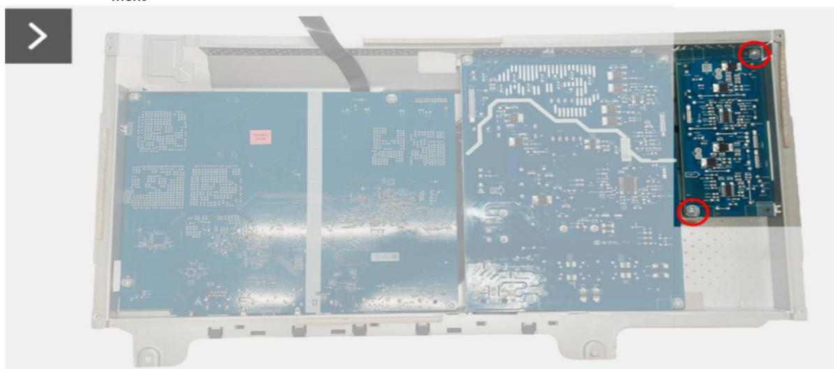
**Figura 11.** Retirar la placa de control LED
