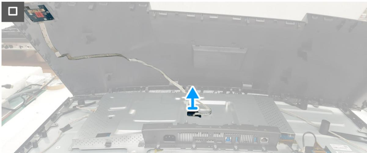
**Figura 16.** Retirar la cubierta posterior
