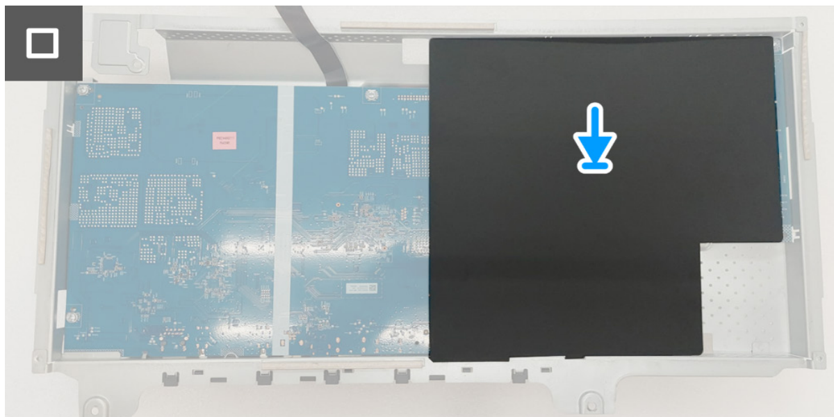
Immagine 26. Installazione della scheda driver LED
