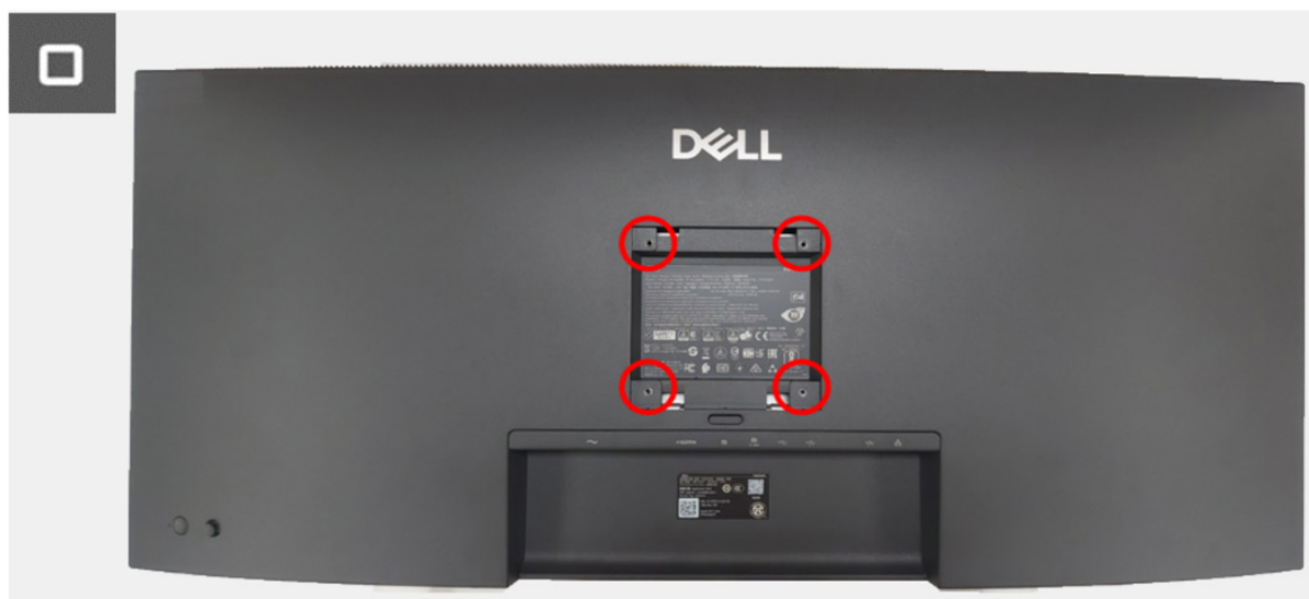
Rysunek 6. Montaż tylnej pokrywy
