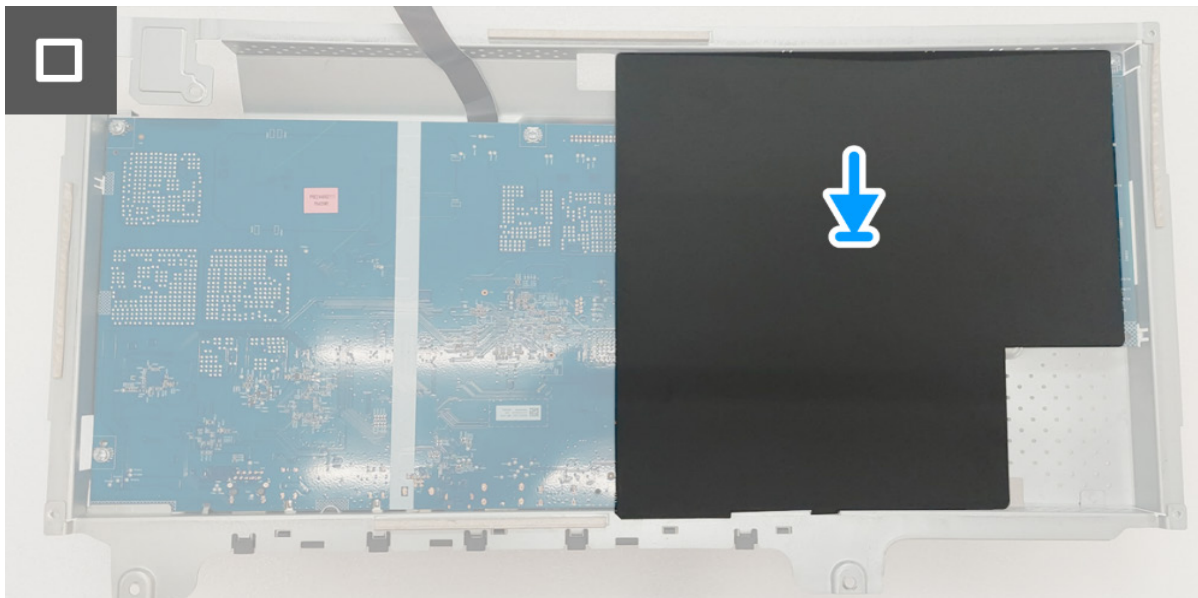
Rysunek 14. Montaż płytki sterownika LED
