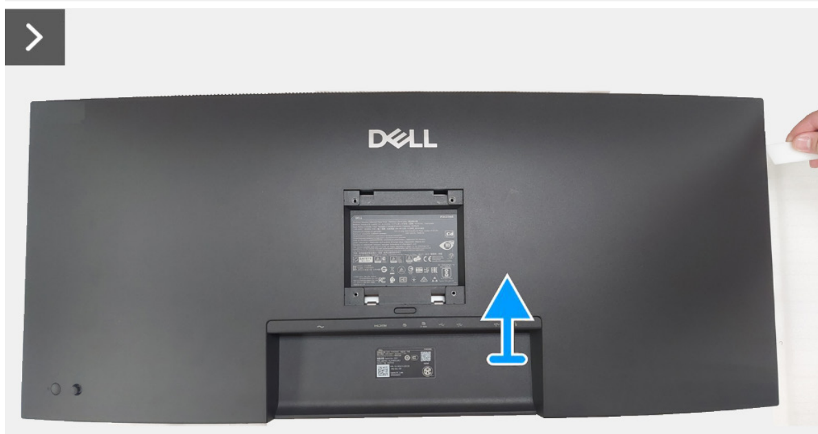
Rysunek 3. Demontaż tylnej pokrywy
