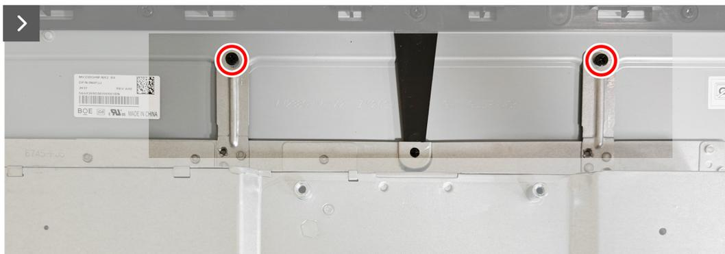
**Figure 15.** Installer le châssis métallique
