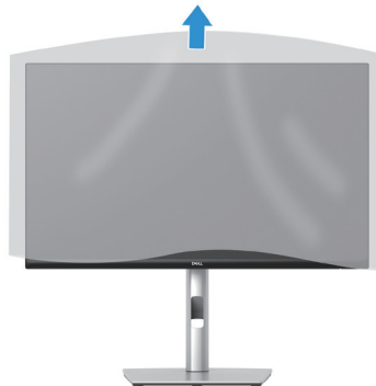
Afbeelding 18. Verwijder het deksel van de monitor
