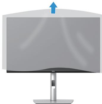
**Figura 18. Remover a cobertura do monitor**
