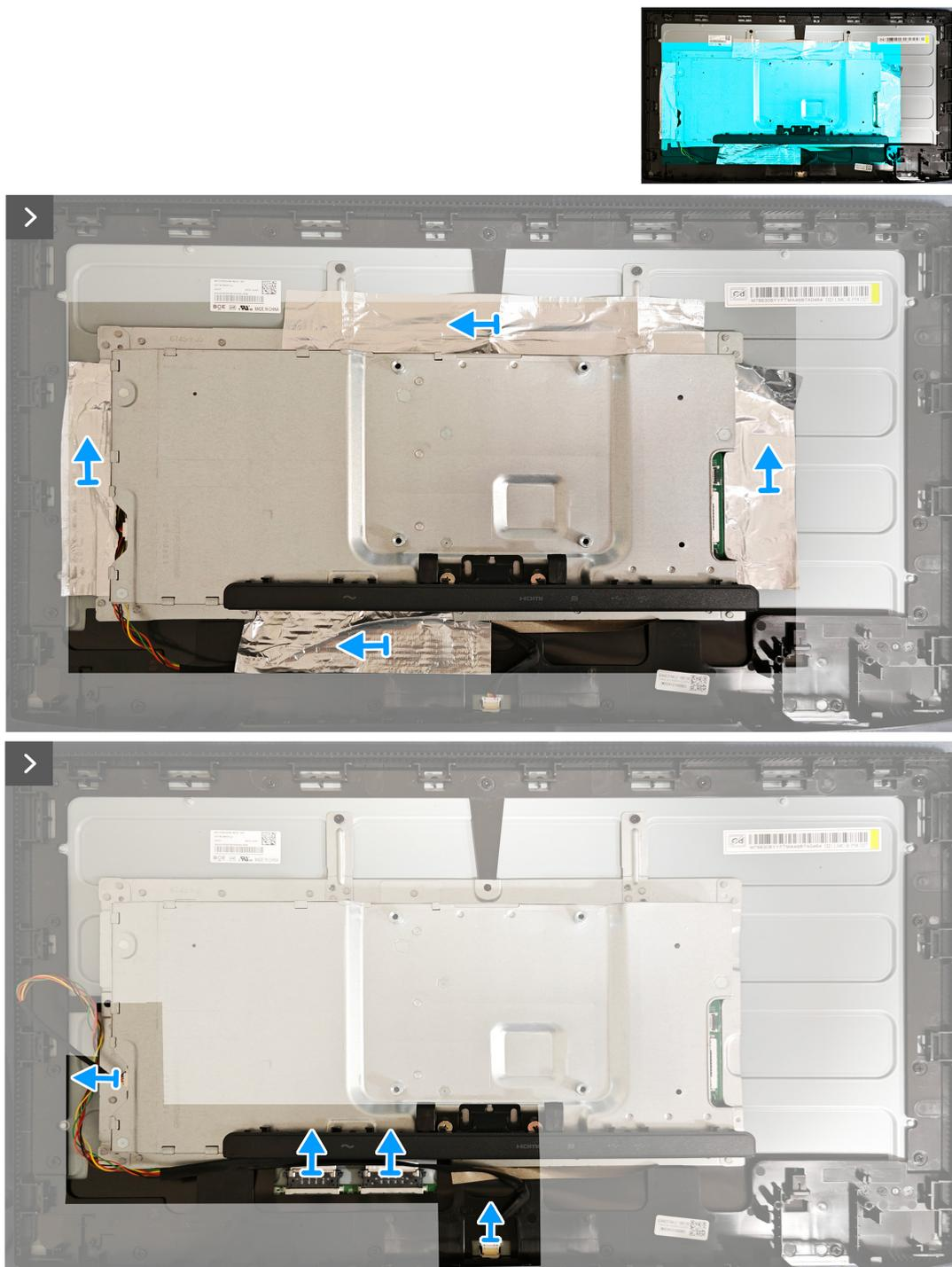
**Figure 21. Enlever le châssis métallique**
