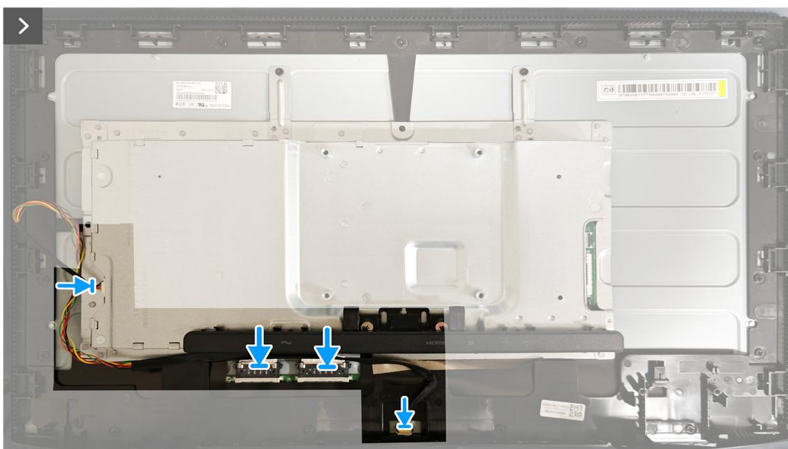
**Figure 24.** Installer le châssis métallique
