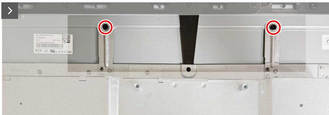
**Figure 23.** Installer le châssis métallique
