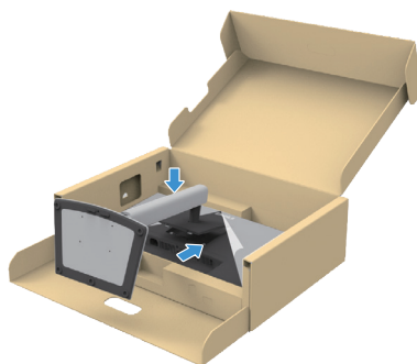
Bild 16. Fästa stativet på skärmen.
