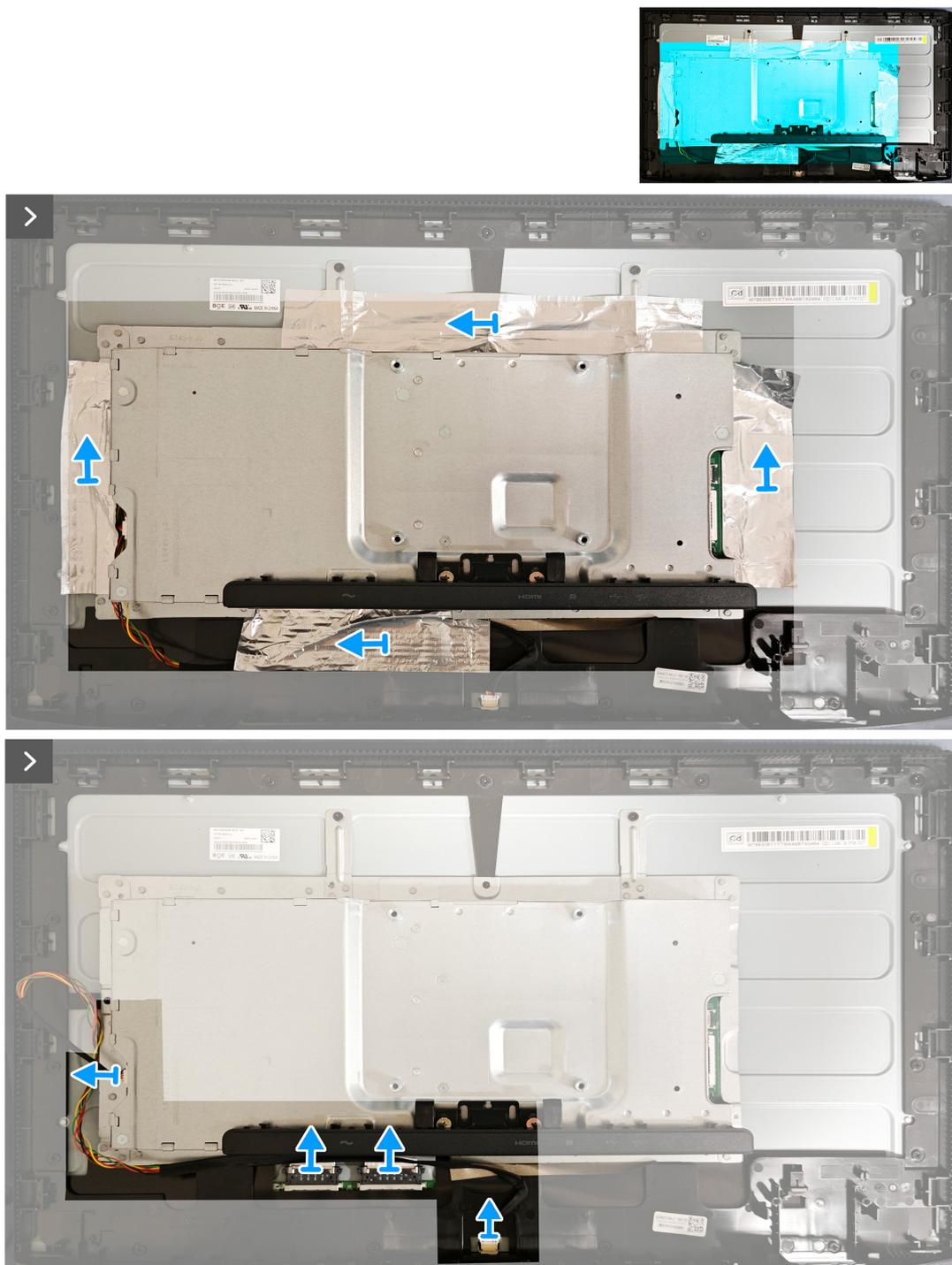
**Figura 13.** Remover a estrutura metálica
