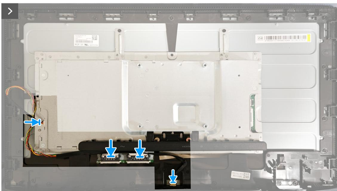
**Figura 16.** Instalar a estrutura metálica
