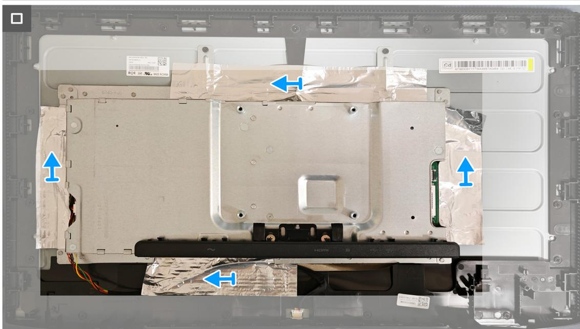
**Figura 17.** Instalar a estrutura metálica
