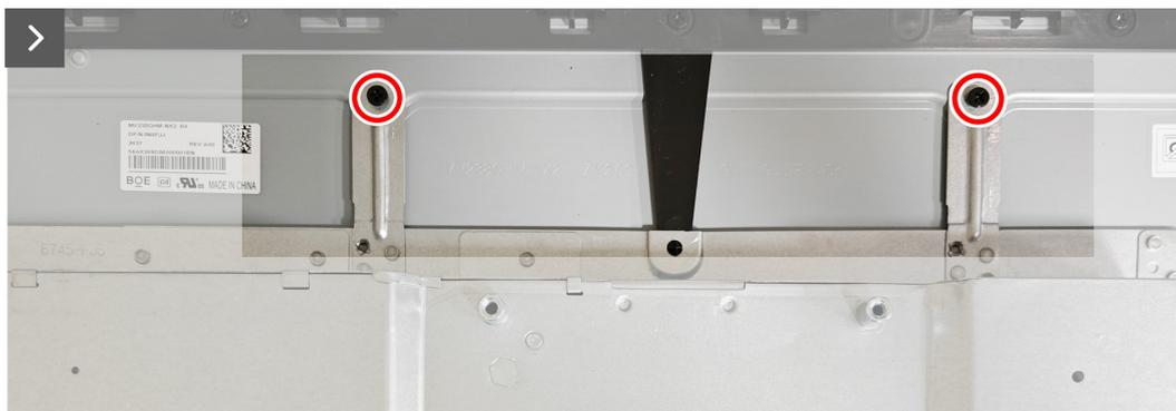
**Figura 15.** Instalar a estrutura metálica
