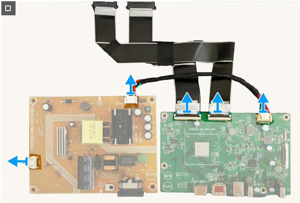
**Figura 19.** Remover a placa do sistema e a placa de alimentação
