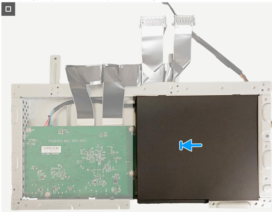
**Figura 22.** Instalar a placa do sistema e a placa de alimentação
