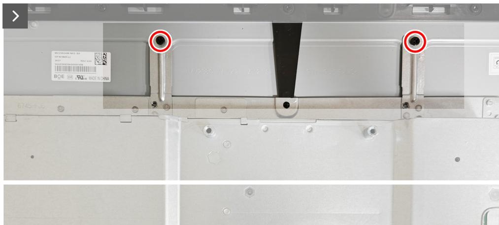
**Figura 14.** Remover a estrutura metálica
