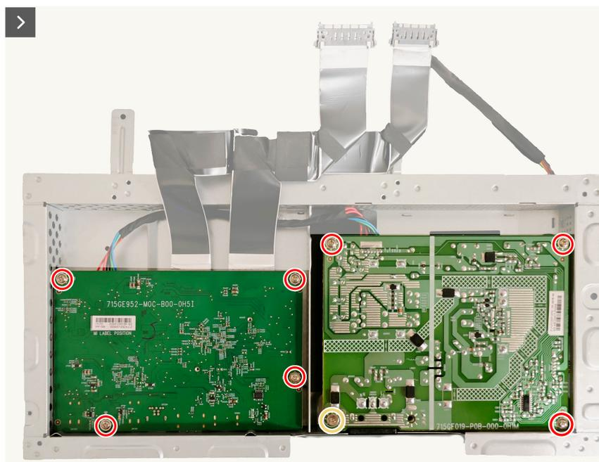
**Figura 21.** Instalar a placa do sistema e a placa de alimentação
