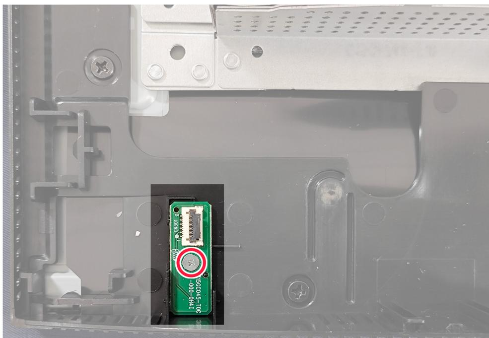
**Figura 18.** Installazione della scheda LENS
