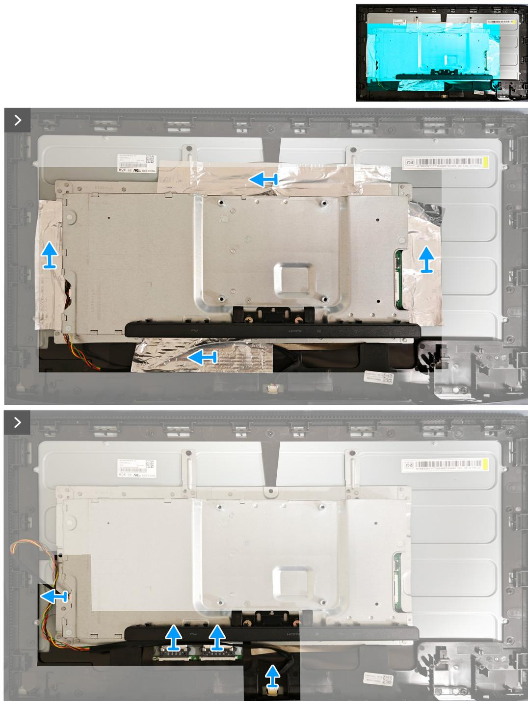
**Figura 21. Rimozione del telaio in metallo**
