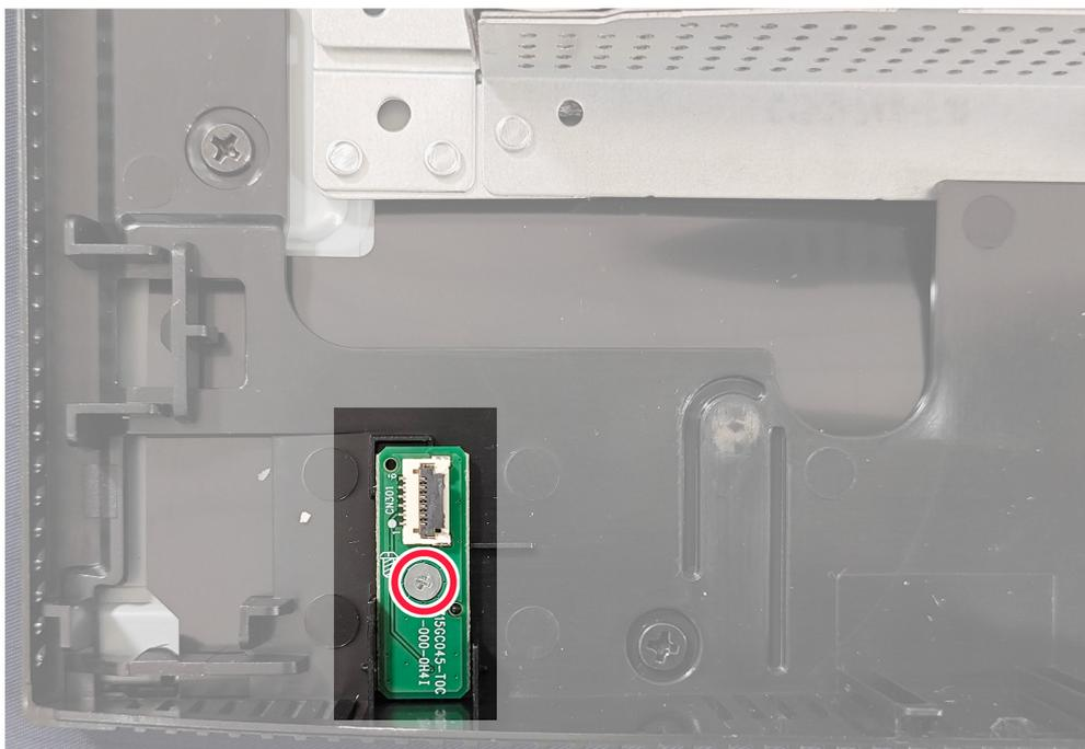
**Figura 17.** Rimozione della scheda LENS
