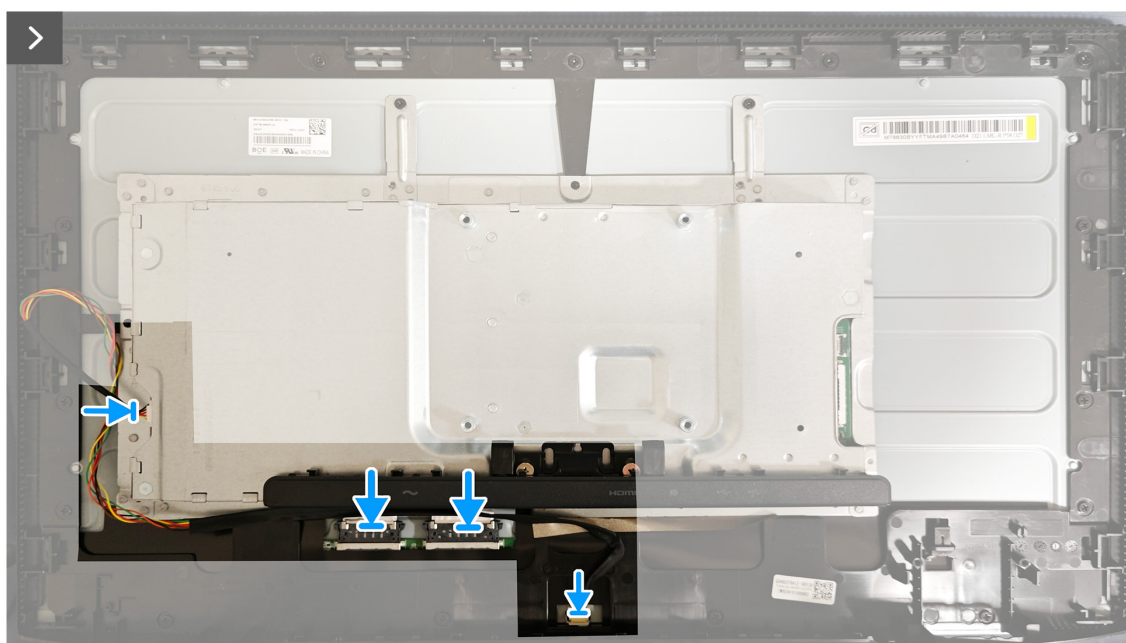
Figura 24. Instalar a estrutura metálica
