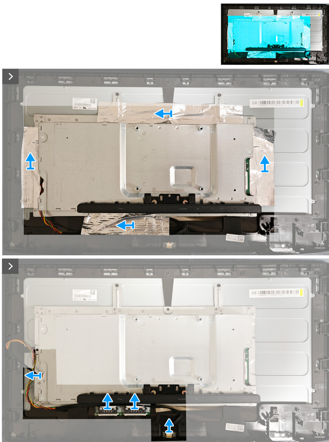
Figura 21. Remover a estrutura metálica
