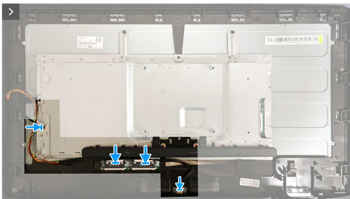
Figura 16. Installazione del telaio in metallo
