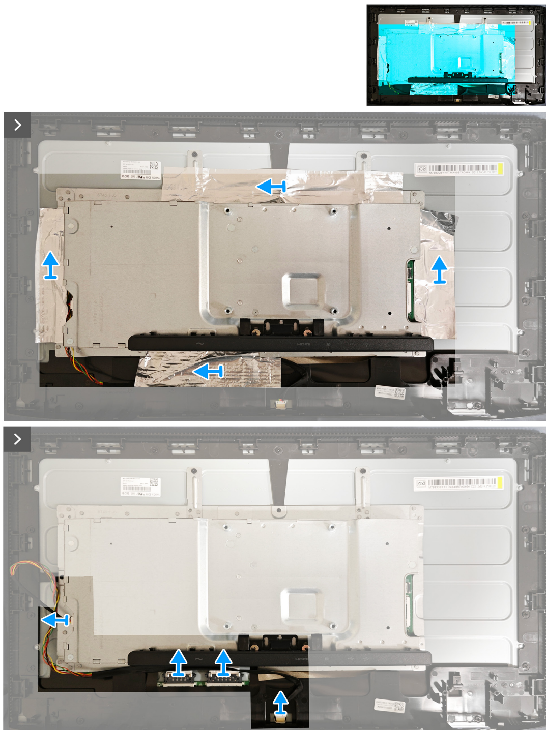
Figura 13. Rimozione del telaio in metallo
