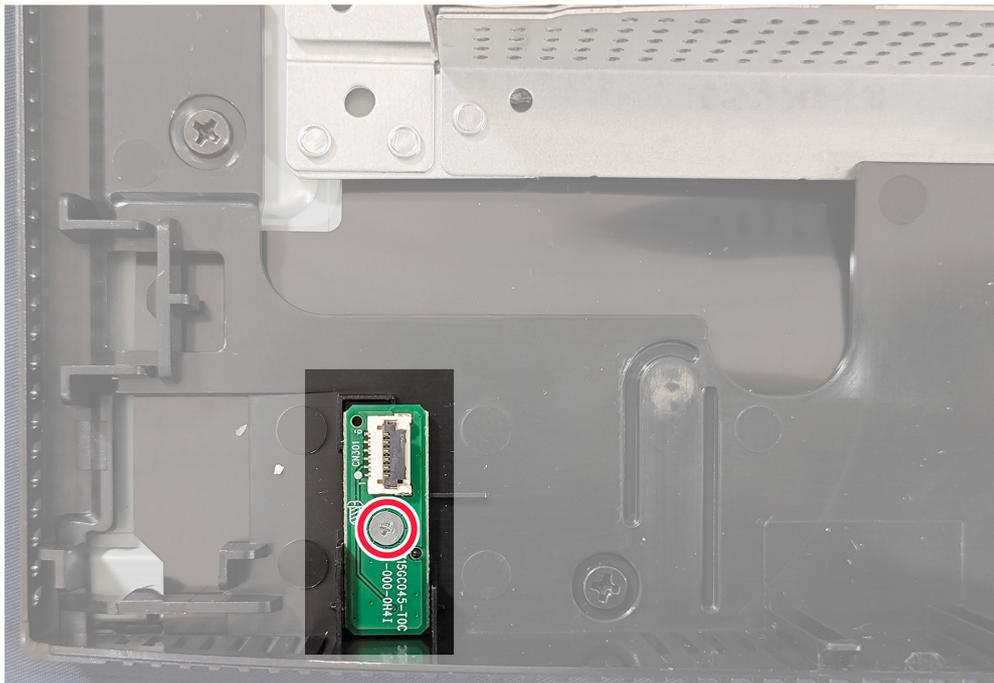
**Figura 9.** Retirar la placa LENS
