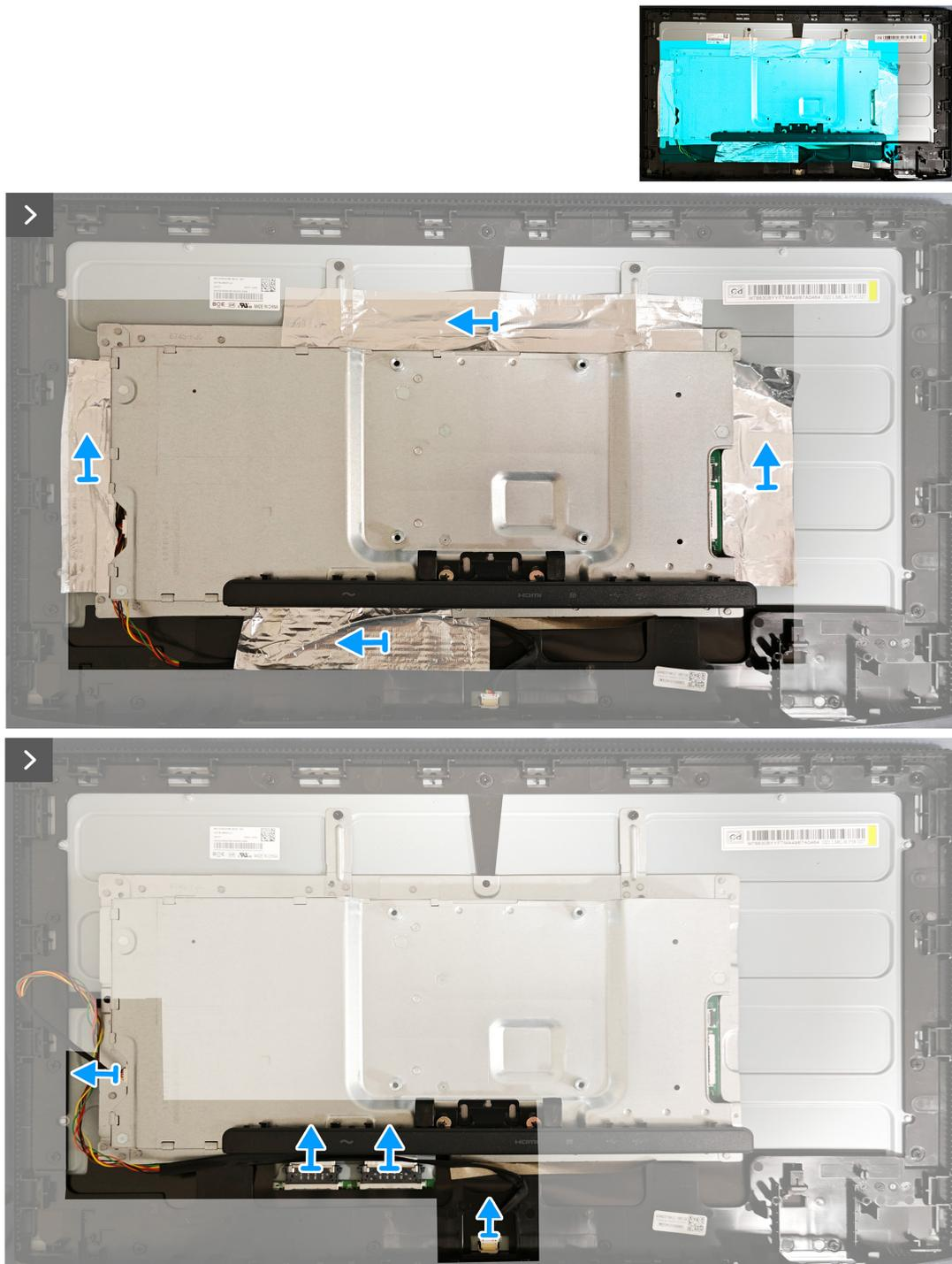
**Figura 13. Retirar el marco metálico**
