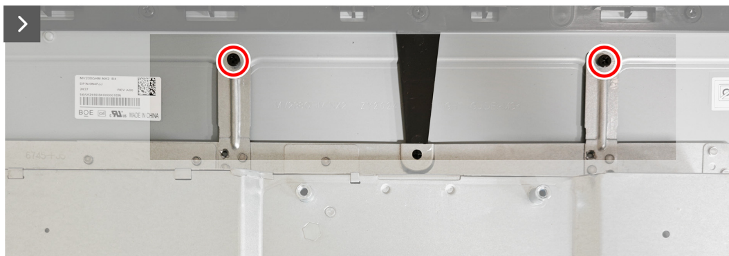
Rysunek 15. Instalacja metalowej ramy
