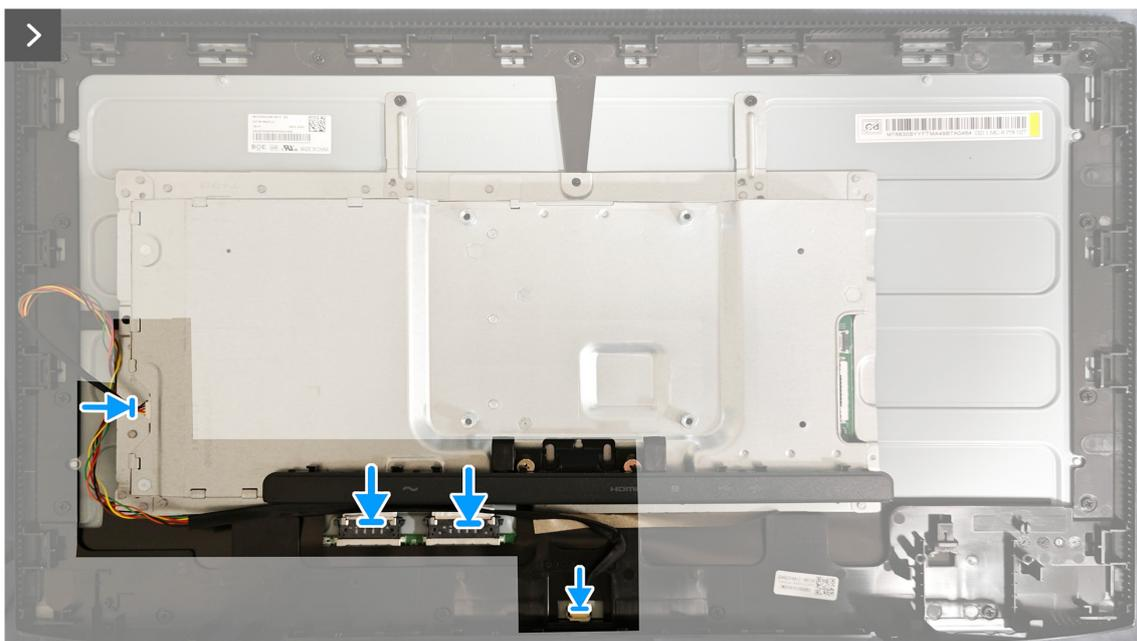
**Figura 24. Instalar el marco metálico**
