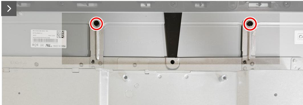
**Figura 23. Instalar el marco metálico**
