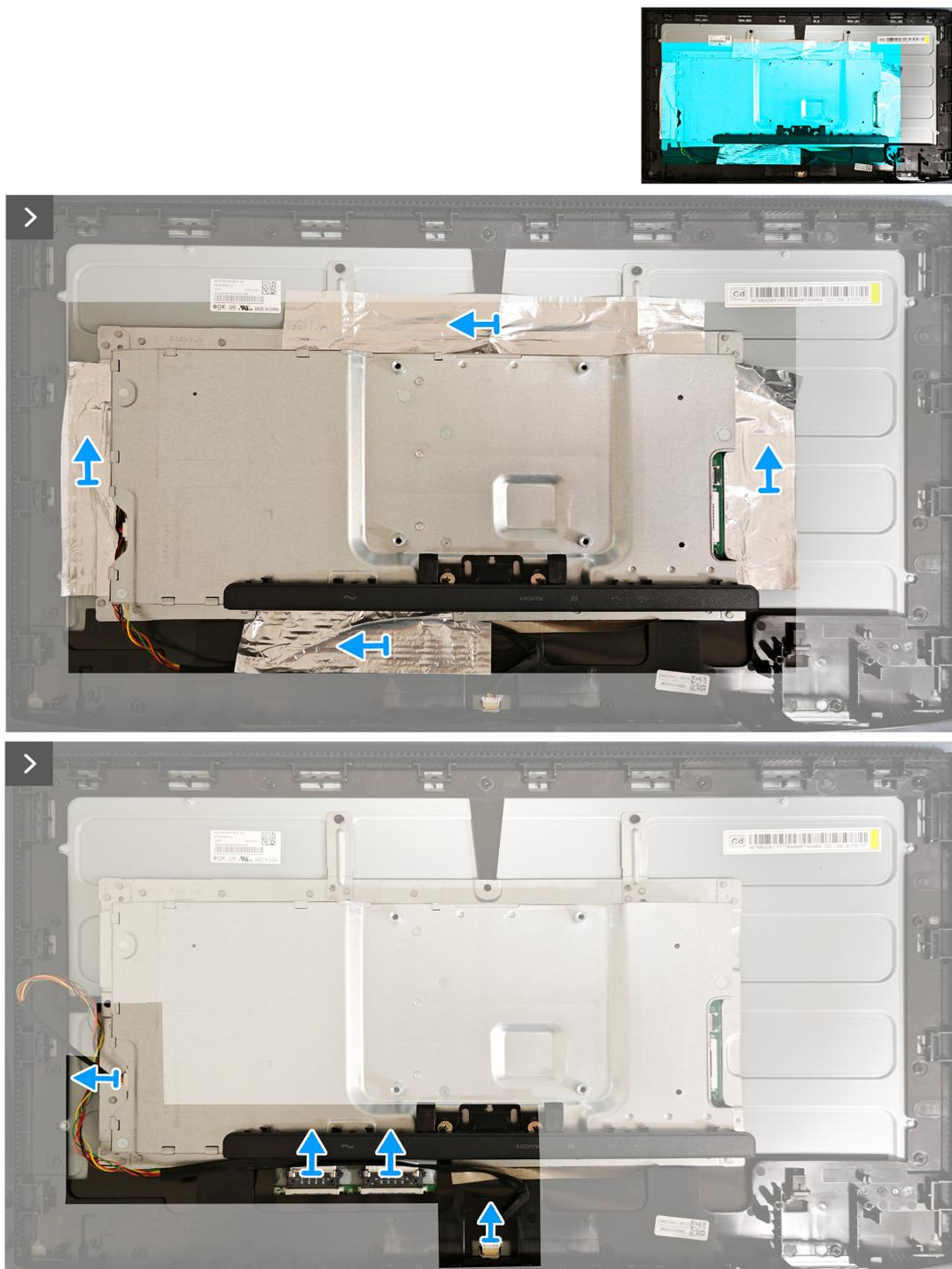
**Figura 21. Retirar el marco metálico**
