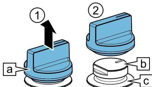
Um den Bedienknebel aufzusetzen, drücken Sie diesen an der ursprünglichen Stelle auf.
