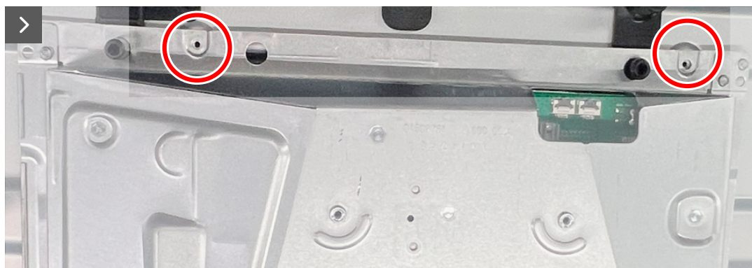
Figure 16. Installer le blindage métallique
