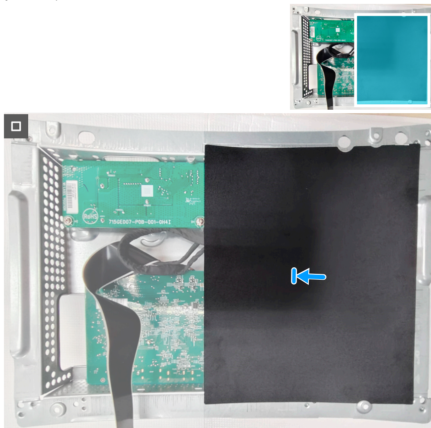
Figura 25. Instalar la placa del sistema y la placa de alimentación
