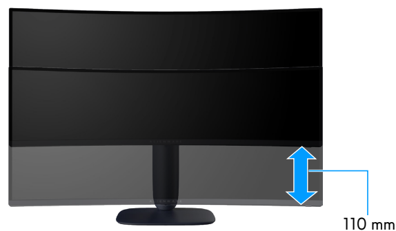
Figure 19. Réglage de la hauteur
