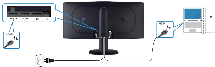
Figure 23. Branchement du câble HDMI
