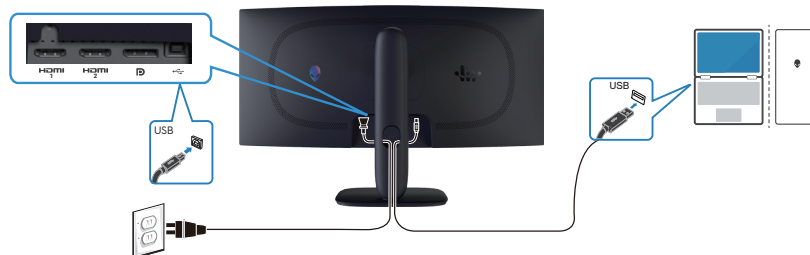
Figure 24. Branchement du câble USB type B (type B à type A)
