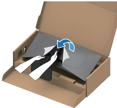
**Figura 16. Segure na coluna e levante o monitor**
