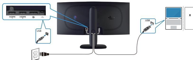
Figura 24. Ligar o cabo USB Tipo B (Tipo B para Tipo A)
