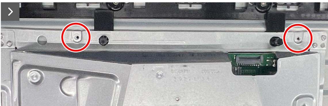
**Figura 12. Remover a blindagem metálica**
