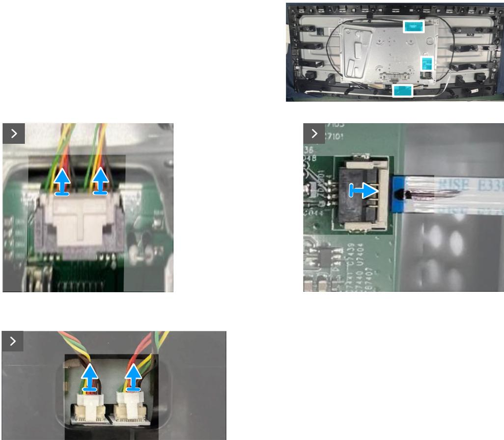
**Figura 11. Remover a blindagem metálica**
