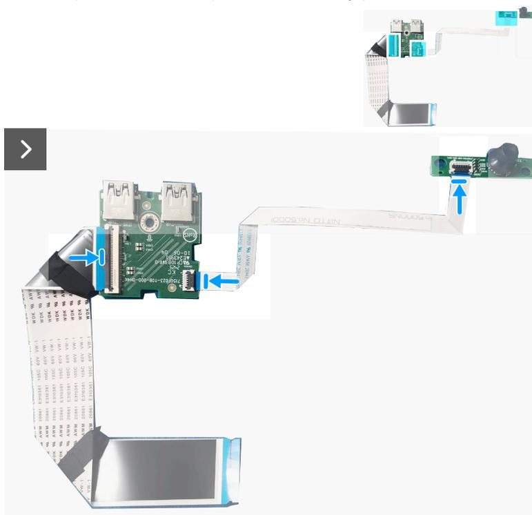
**Figura 33. Instalar a placa de E/S e a placa do botão do joystick**
