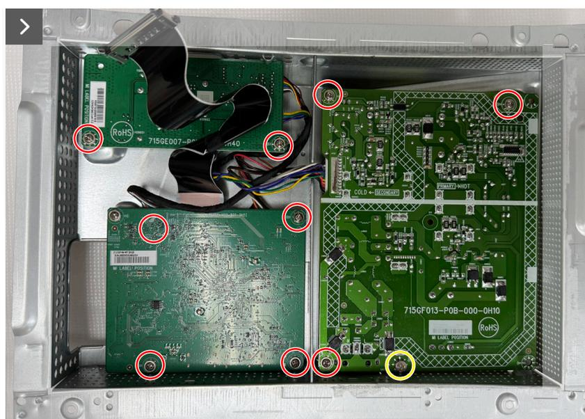
**Figura 24. Instalar a placa do sistema e a placa de alimentação**
