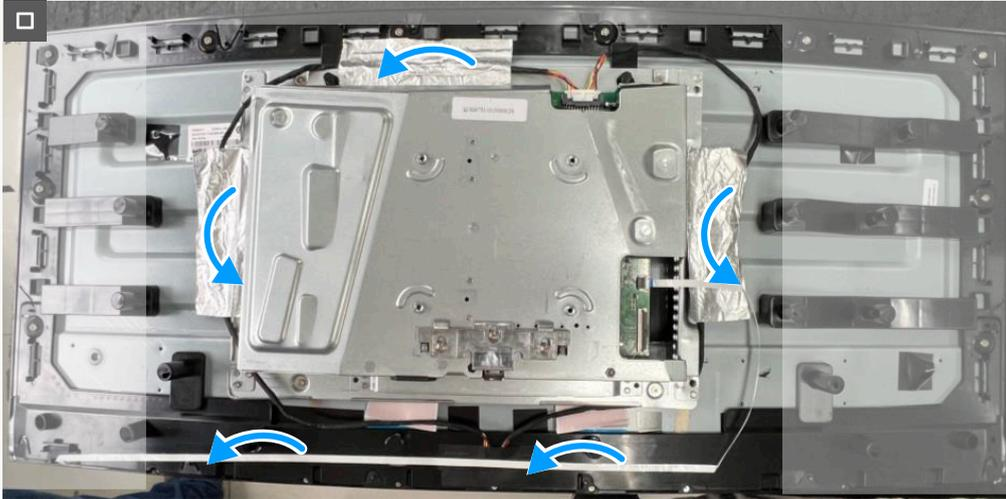
**Figura 19. Instalar a blindagem metálica**
