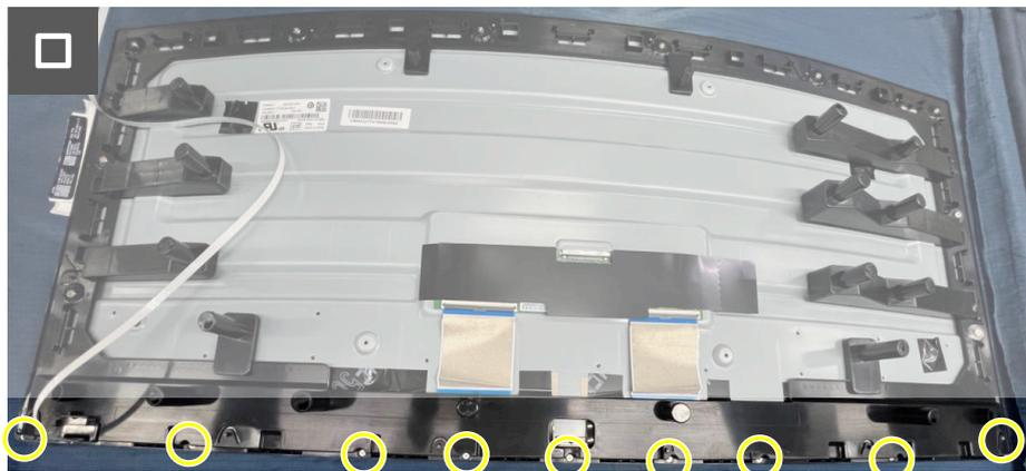
**Figura 26. Remover a estrutura intermédia**
