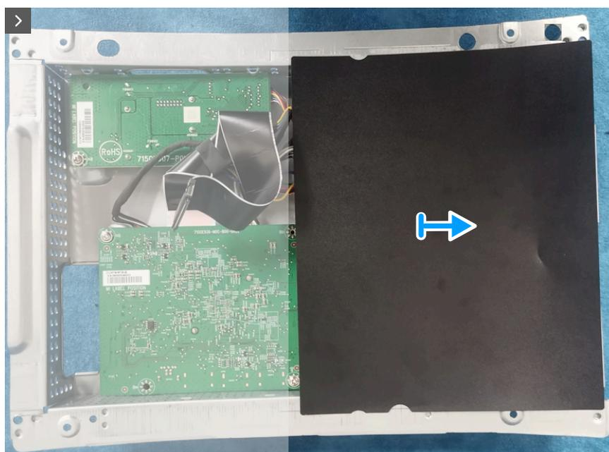
**Figura 20. Remover a placa do sistema e a placa de alimentação**
