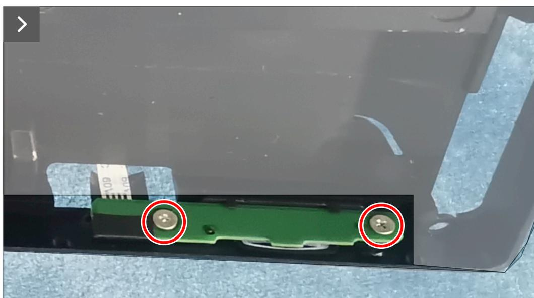
**Figura 30. Instalar a placa do botão de energia**
