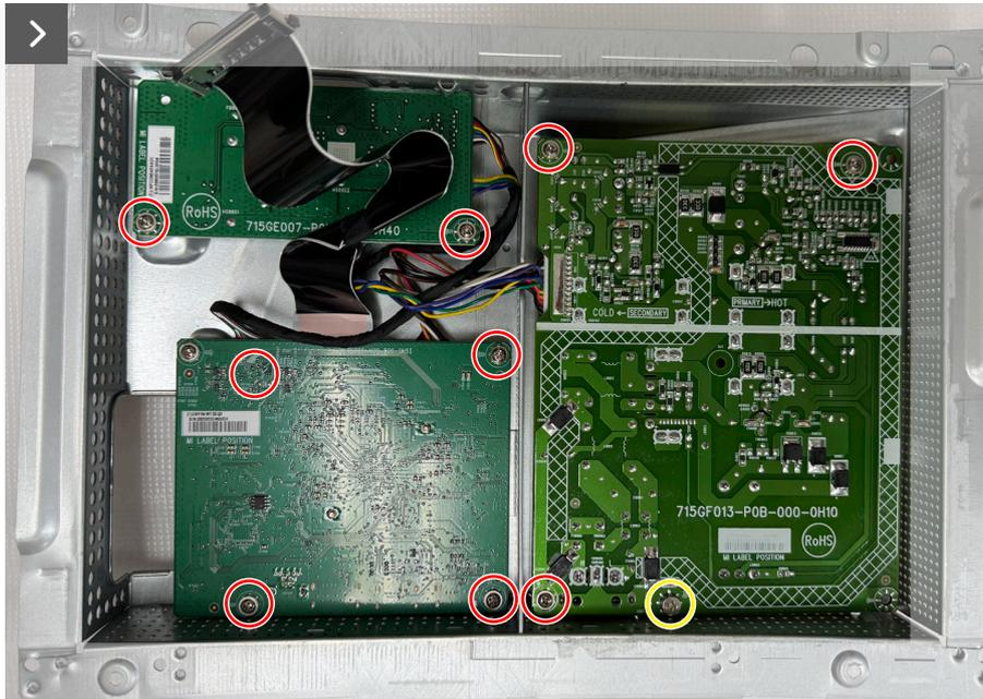
**Figura 21. Remover a placa do sistema e a placa de alimentação**
