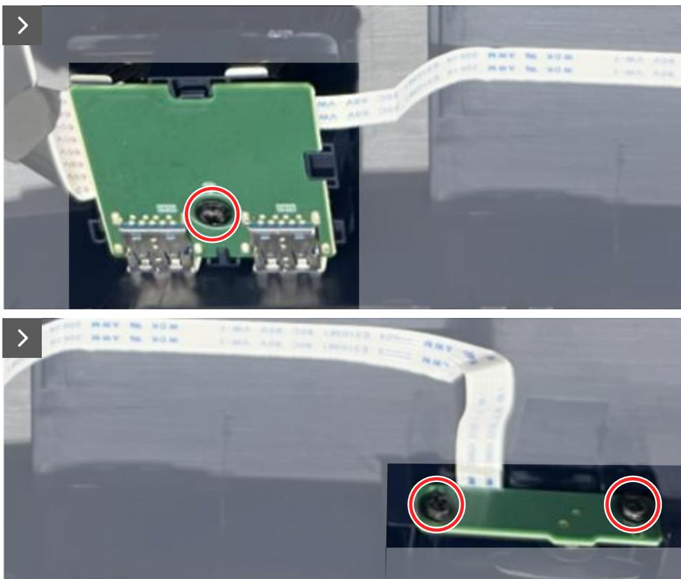
**Figura 31. Remover a placa de E/S e a placa do botão do joystick**
