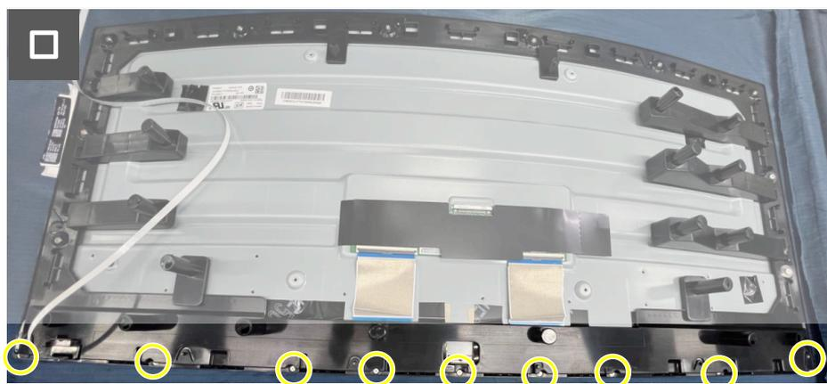
**Figura 27. Instalar a estrutura intermédia**
