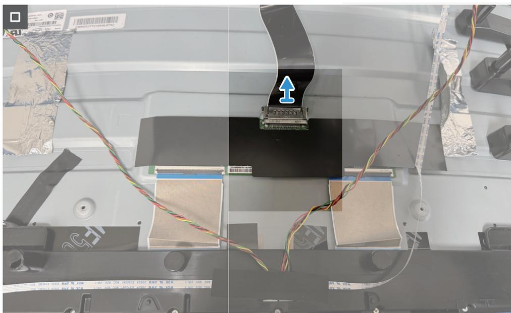
**Figura 14. Remover a blindagem metálica**
