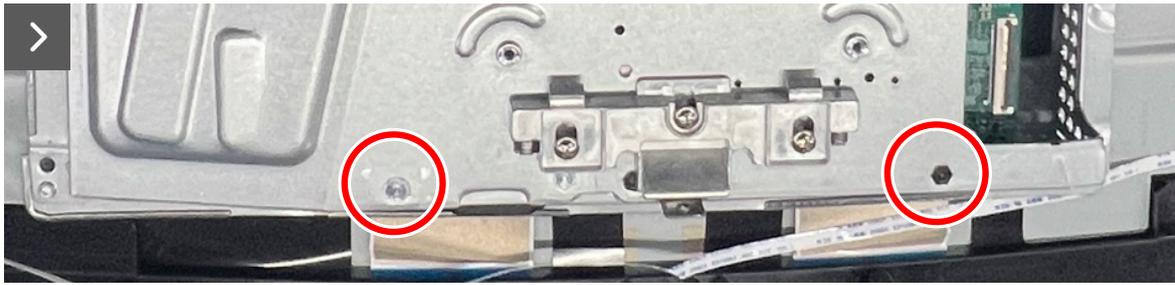
**Figura 17. Instalar a blindagem metálica**
