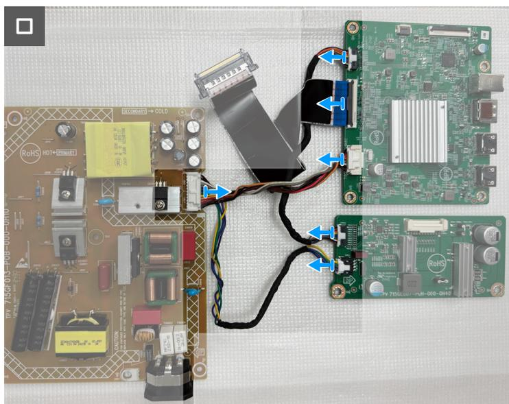
**Figura 22. Remover a placa do sistema e a placa de alimentação**
