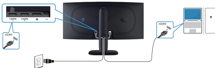
Figure 9. Branchement du câble HDMI
