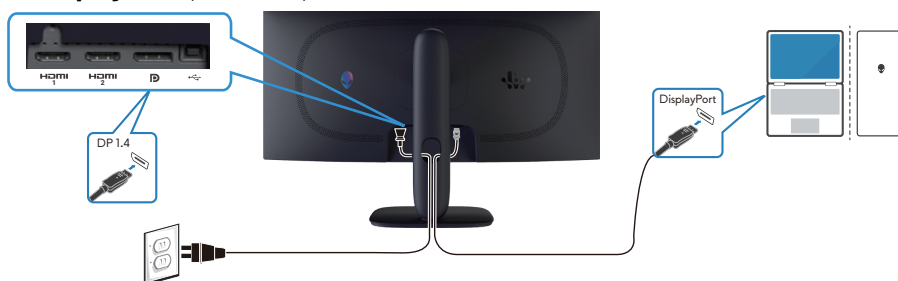
Figure 8. Branchement du câble DisplayPort (DP à DP)
