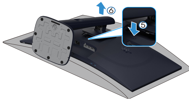
Figura 26. Desmontar el pedestal del monitor
