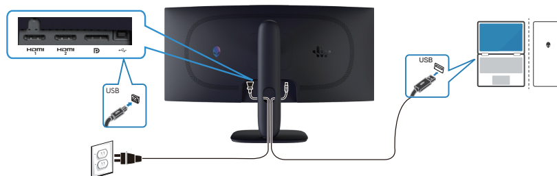
Figura 24. Conectar el cable USB Tipo-B (Tipo-B a Tipo-A)
