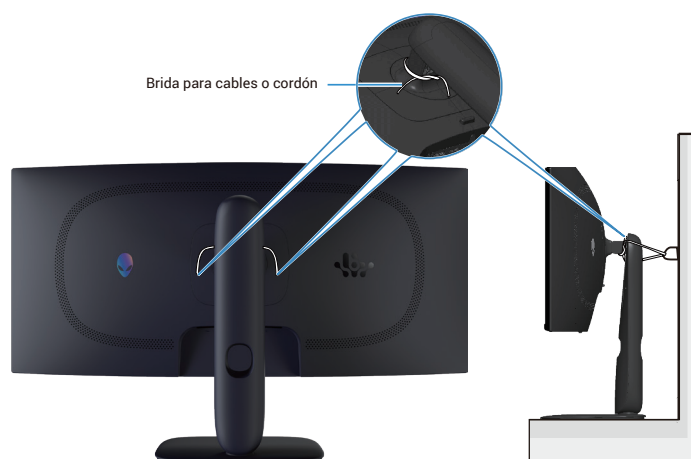
Figura 21. Fijar el monitor
