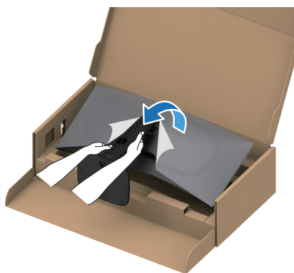
Figura 16. Sujetar el elevador del pedestal y levantar el monitor
