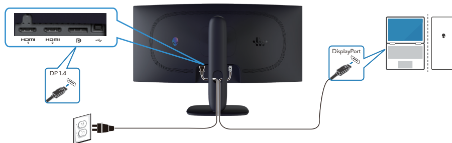
Figura 22. Conectar el cable DisplayPort (DP a DP)
