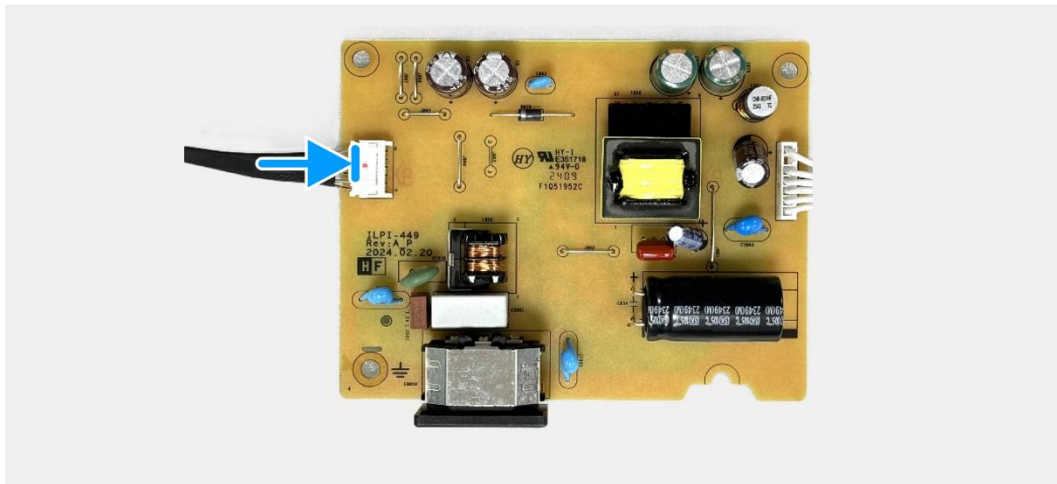
Rysunek 22. Instalacja płyty zasilania
