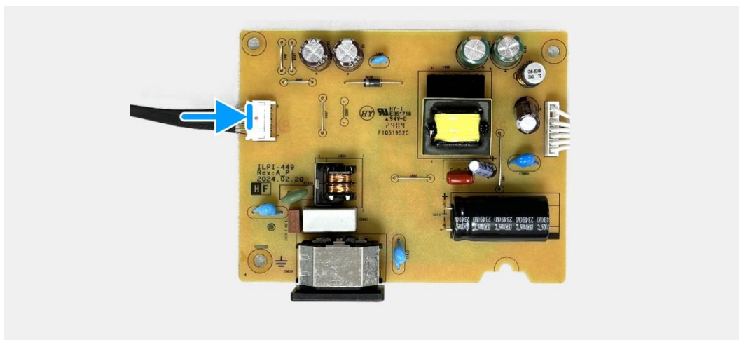
Rysunek 44. Instalacja płyty zasilania
