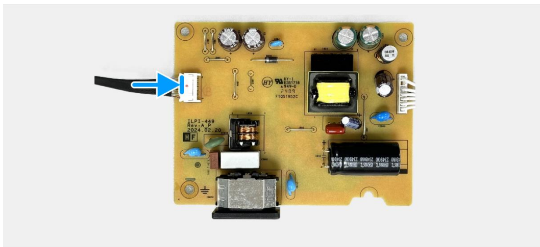
Rysunek 31. Instalacja płyty zasilania
