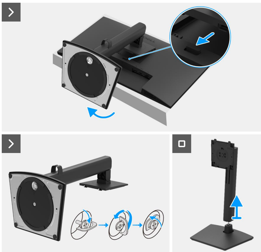
Rysunek 10. Demontaż podstawy
