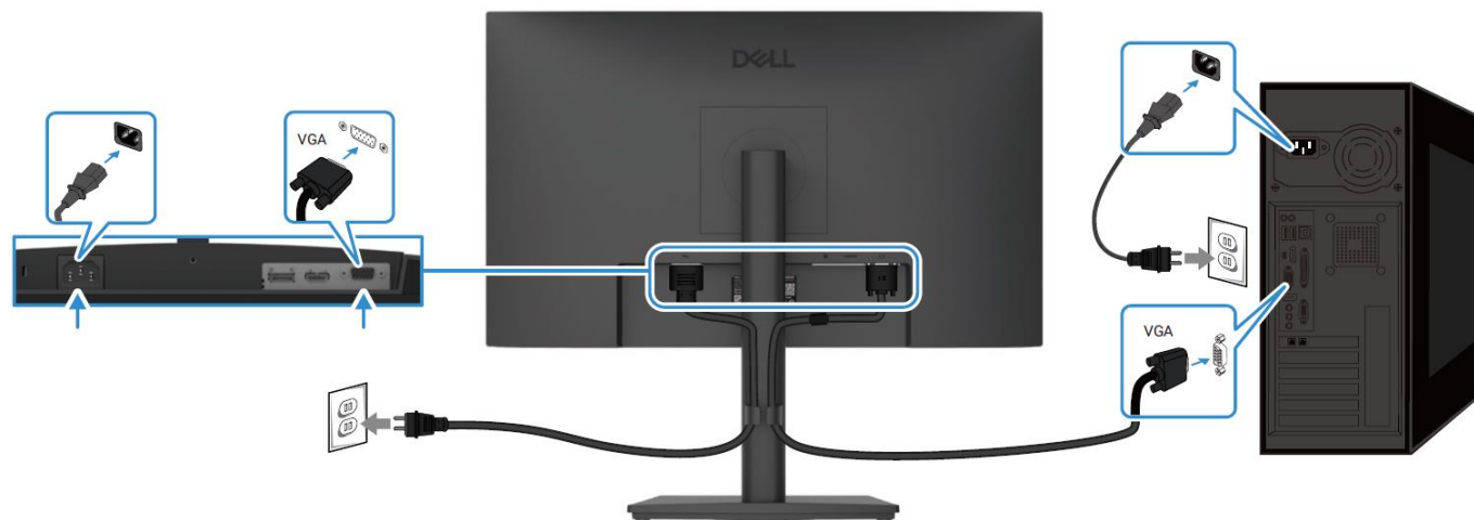
Rysunek 7. Podłączanie kabla VGA
