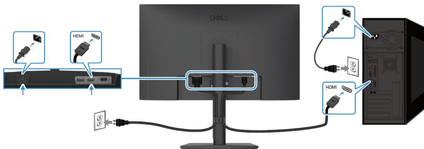
Rysunek 9. Podłączanie kabla HDMI
