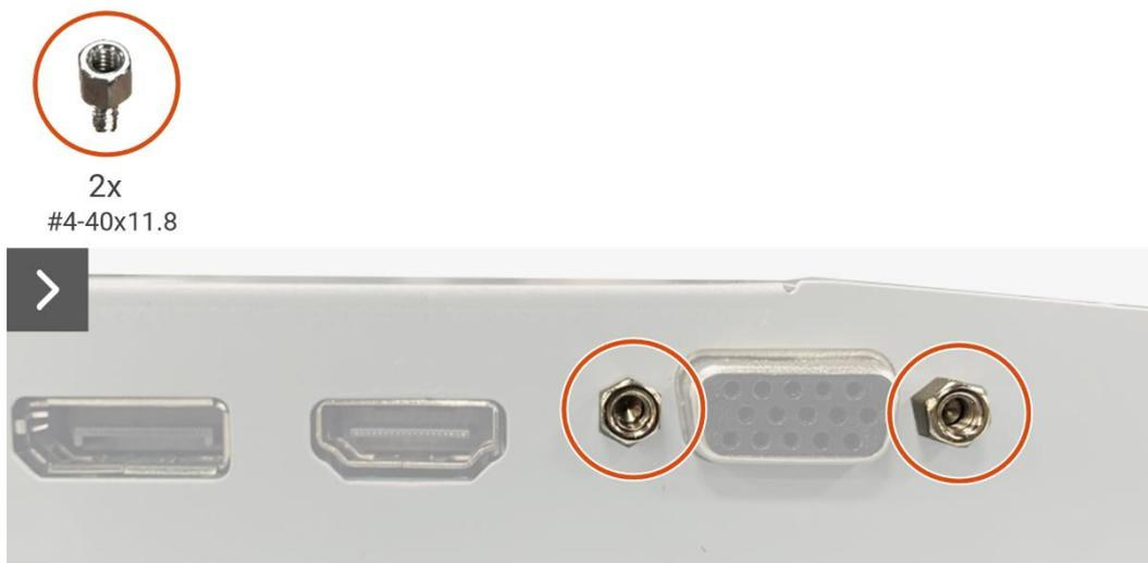
**Figura 24.** Rimozione della scheda di interfaccia
