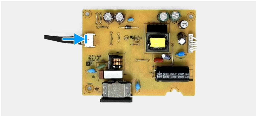
**Figura 31.** Installazione della scheda di alimentazione
