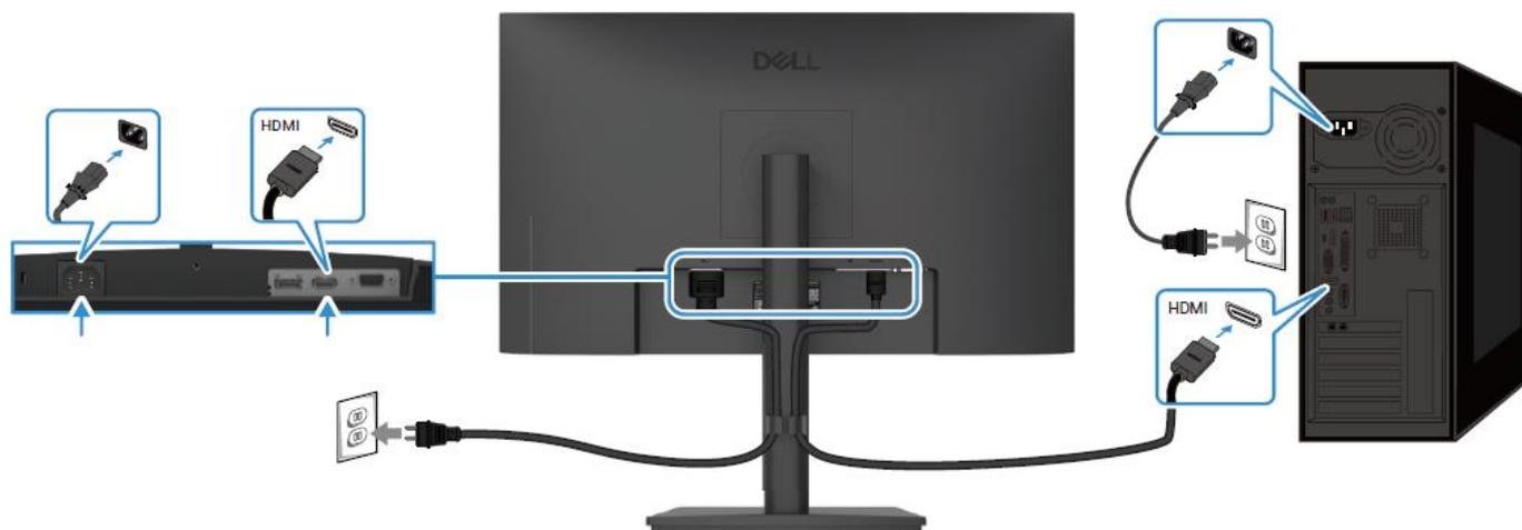
Figura 9. Collegamento del cavo HDMI
