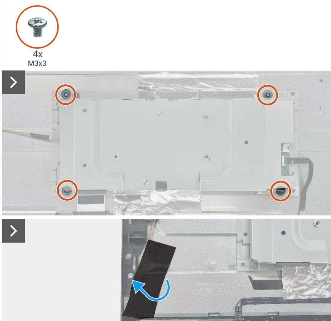
**Figura 40.** Rimozione del gruppo telaio
