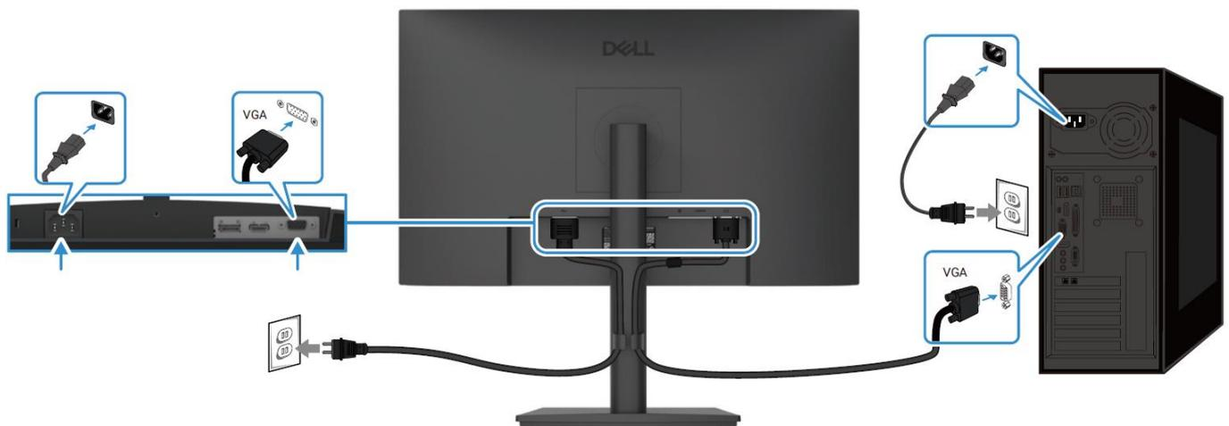
Figura 7. Collegamento del cavo VGA
