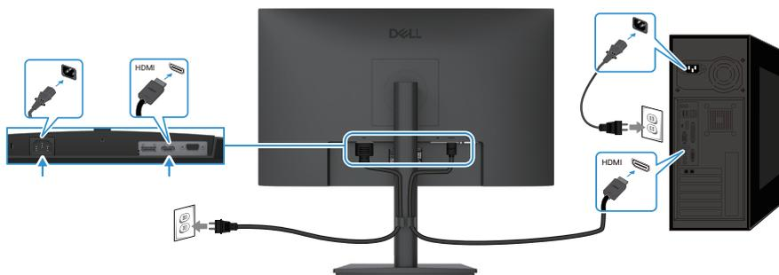
Figura 16. Collegamento del cavo HDMI
