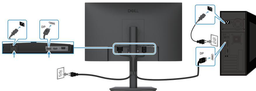
Figura 15. Collegamento del cavo DP
