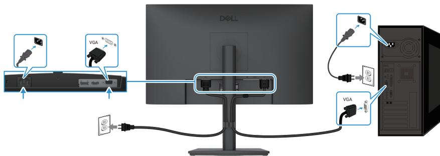
Figura 14. Collegamento del cavo VGA
