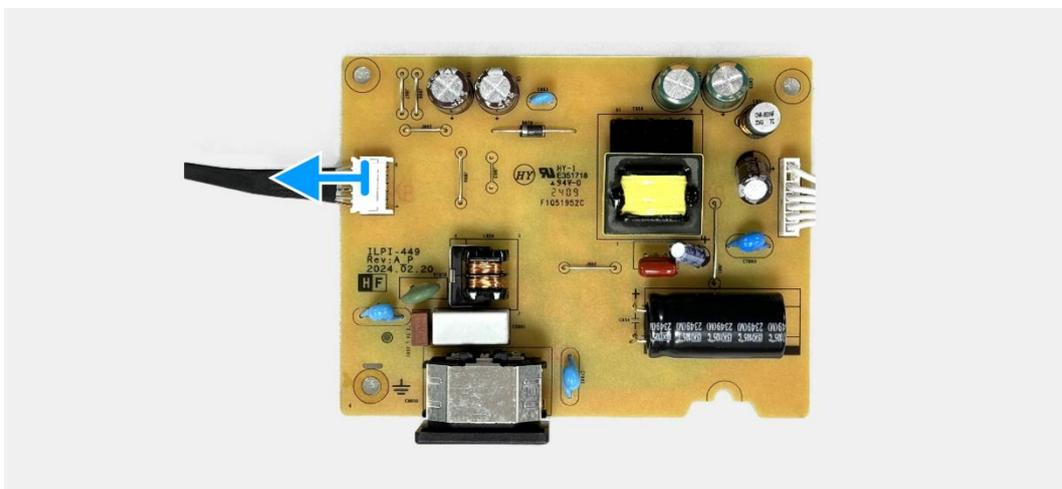
**Figura 30.** Remover a placa de alimentação
