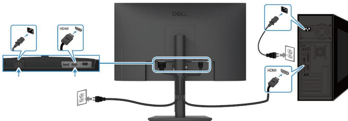
Figura 9. Conectar o cabo HDMI
