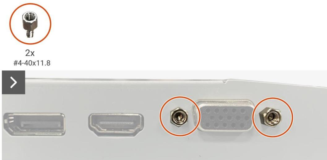
**Figura 46. Remover a placa de interface**
