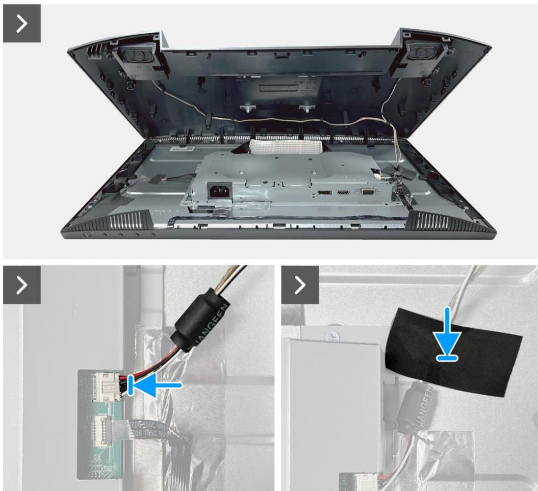
Figura 14. Instalação da tampa traseira
