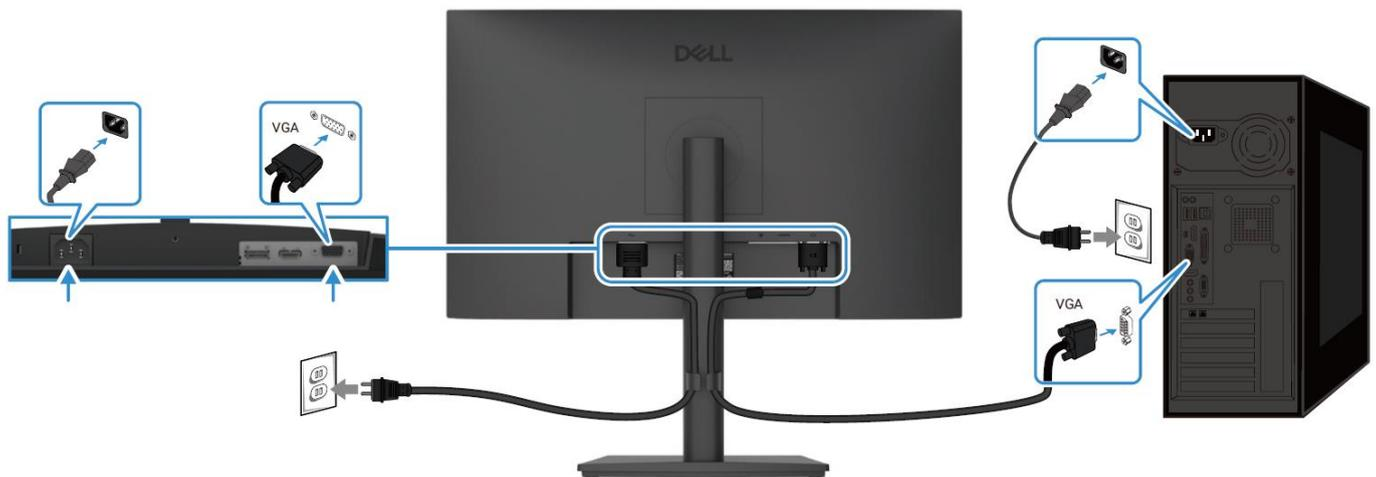
Figura 7. Conectar o cabo VGA
