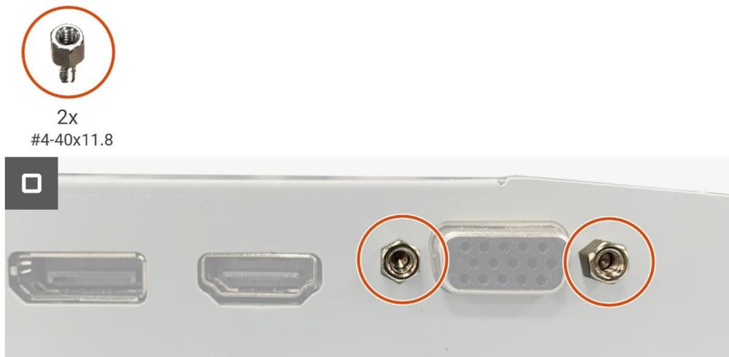
**Figura 51. Instalação da placa de interface**
