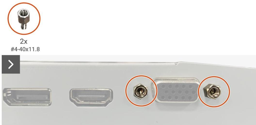
**Figura 24. Remover a placa de interface**
