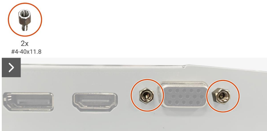
Figura 15. Remover a placa de interface
