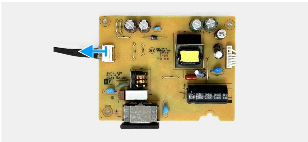
Figura 21. Remover a placa de alimentação
