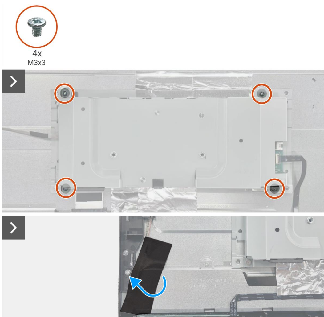
Figura 31. Remover o conjunto da base inferior
