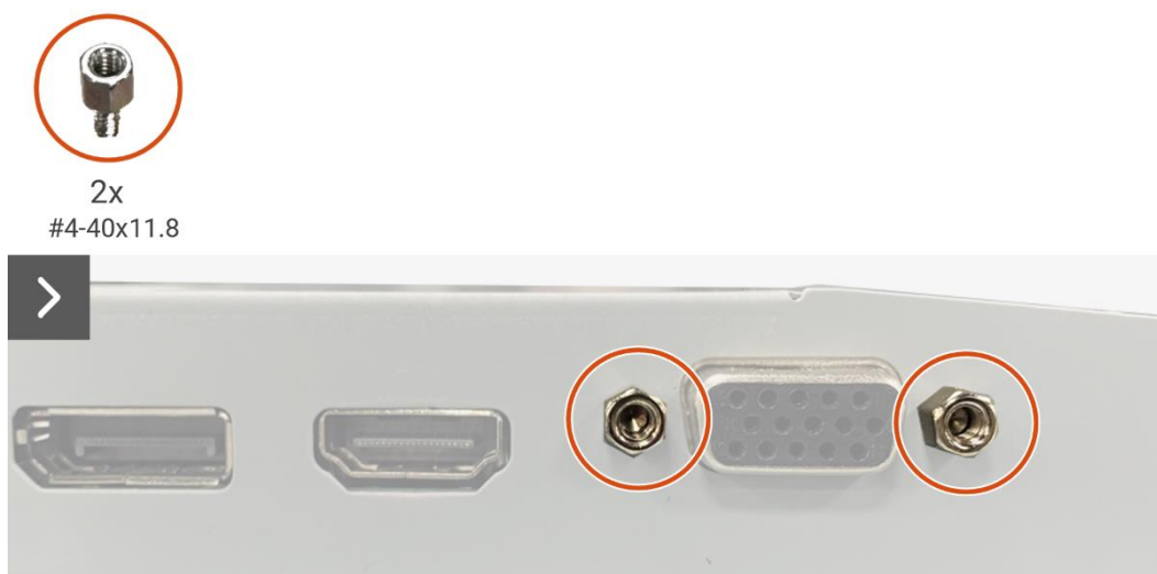
Obrázek 24. Odmontování desky rozhraní
