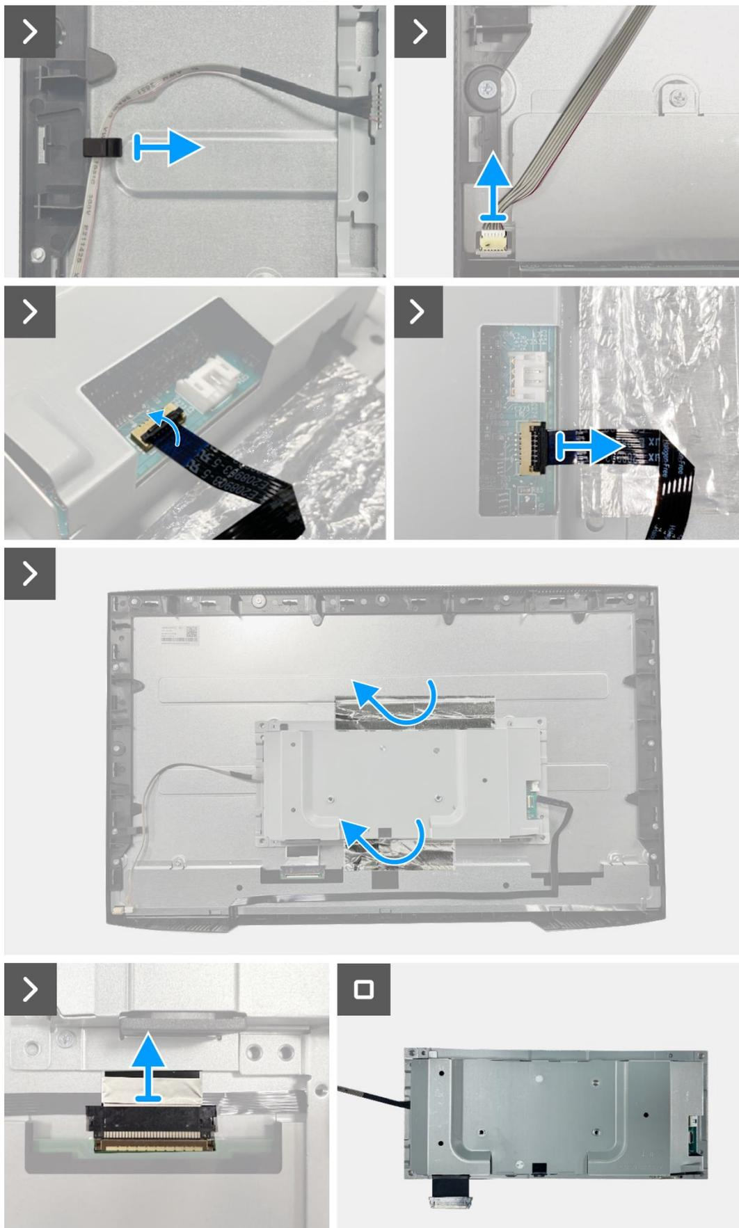
**Figure 41.** Retrait de l'assemblage du cadre
