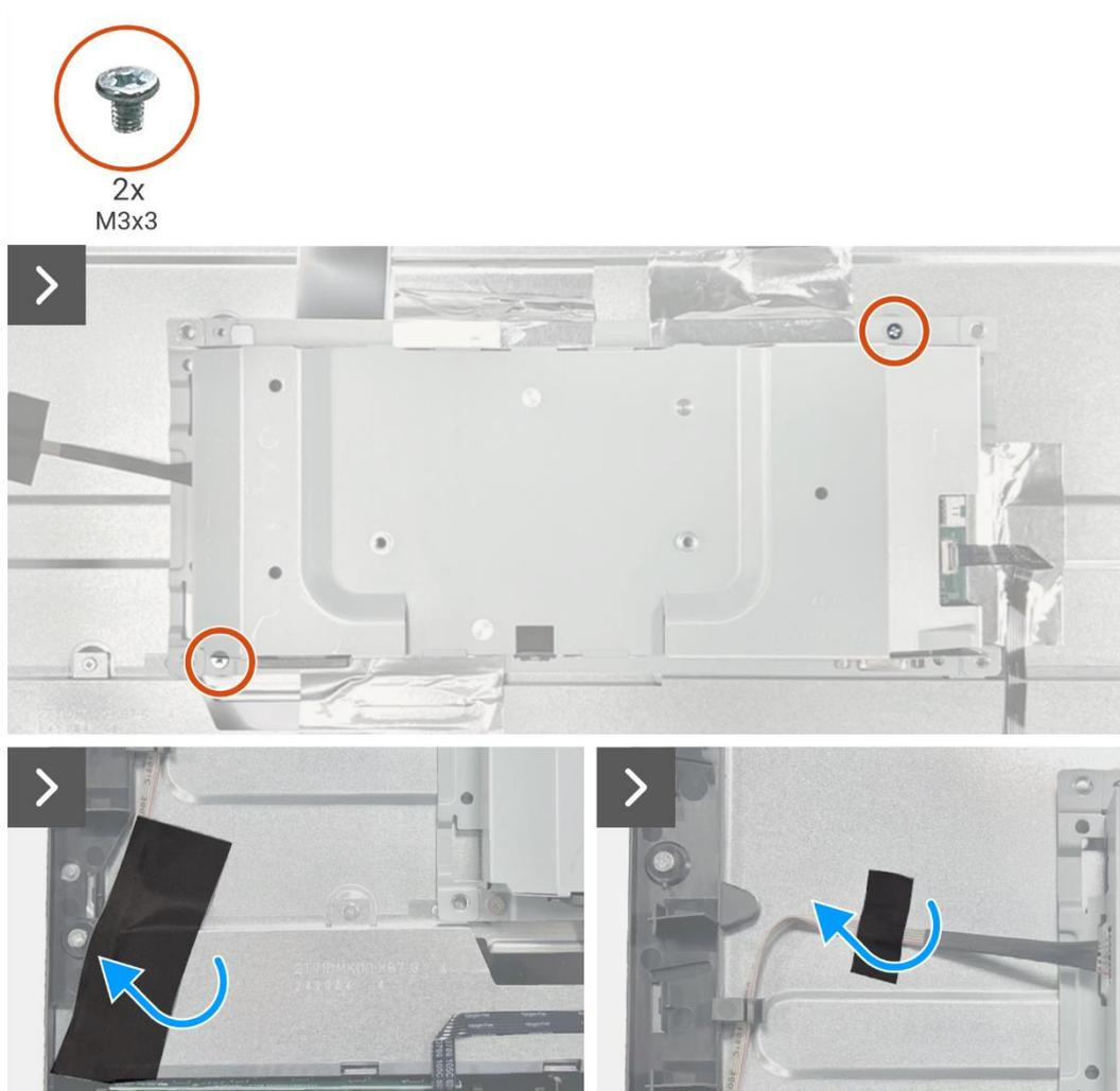
**Figure 18.** Retrait de l'assemblage du cadre
