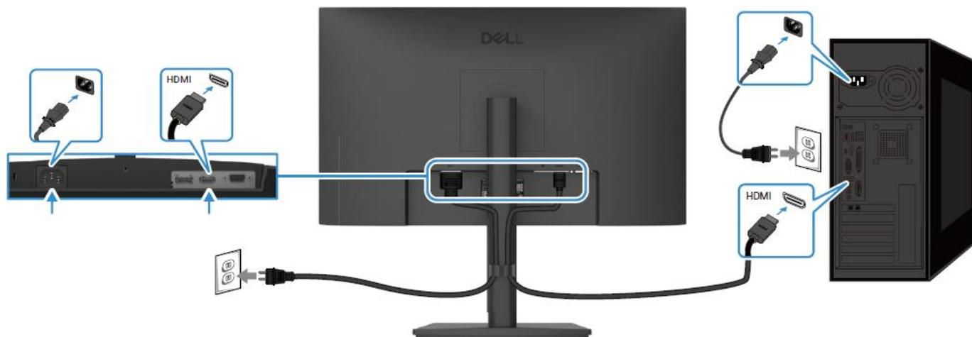
Figure 9. Connexion du câble HDMI
