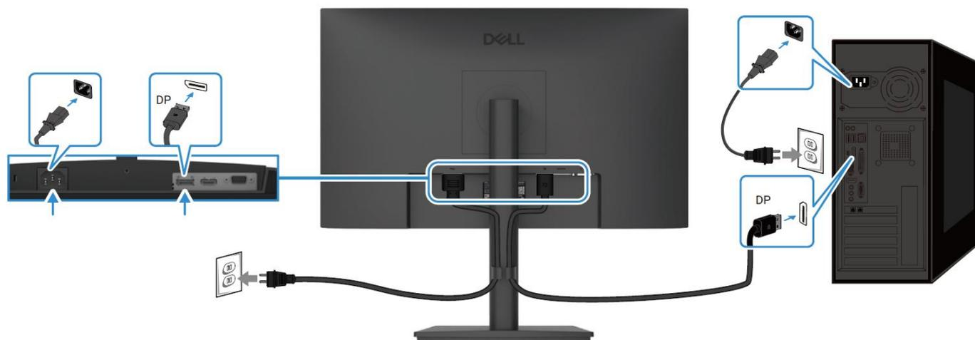
Figure 8. Connexion du câble DP
