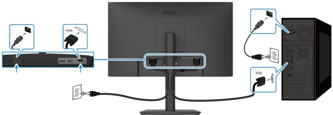
Figure 7. Connexion du câble VGA
