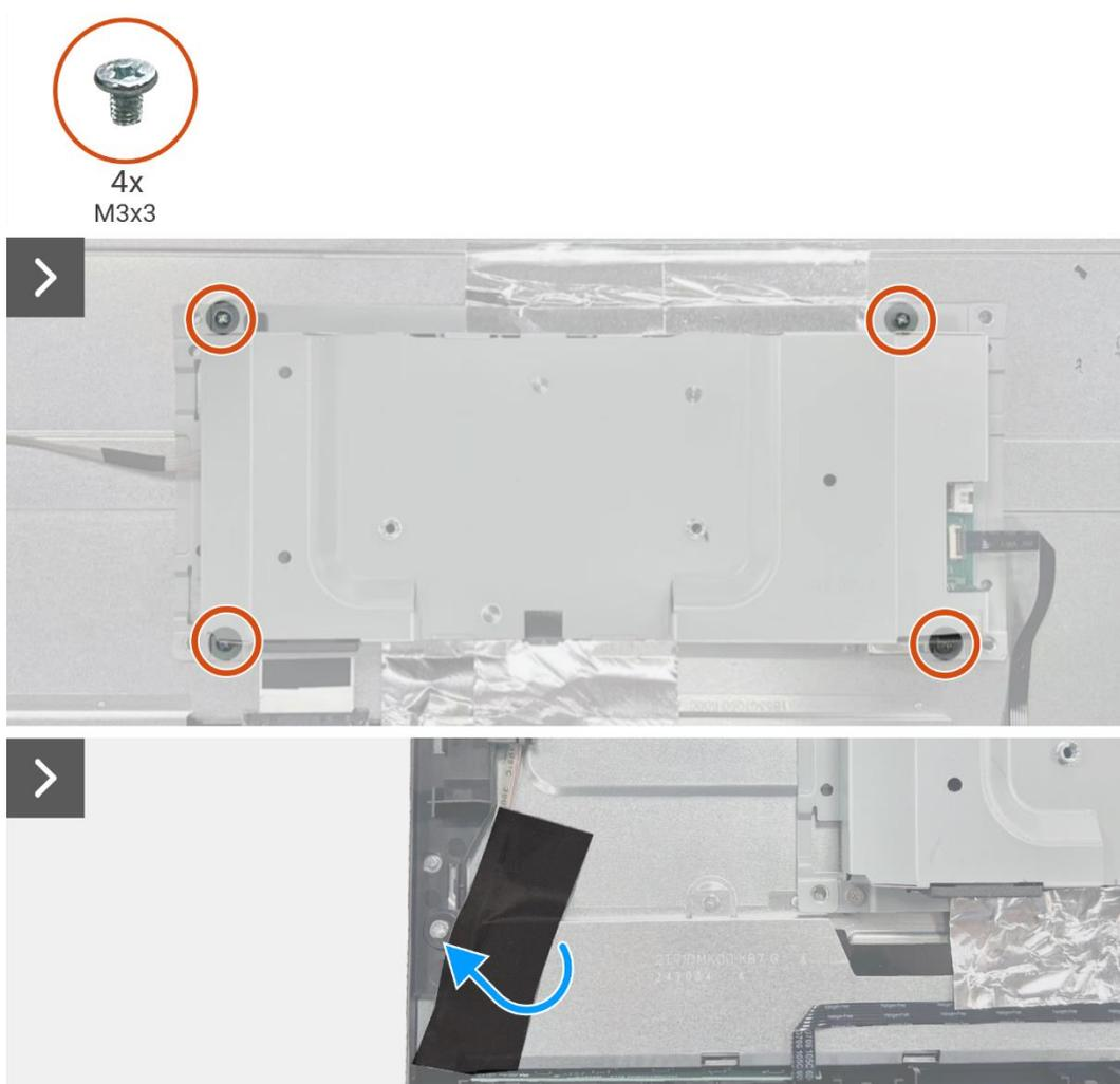
**Figure 40.** Retrait de l'assemblage du cadre
