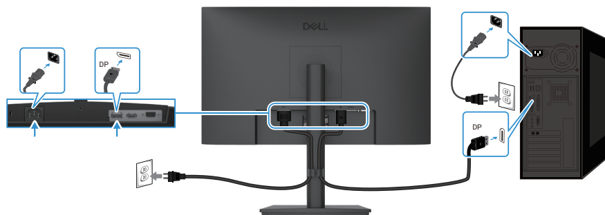
Abbildung 15. Anschließen des DP-Kabels
